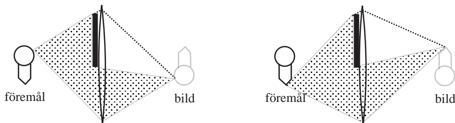
Figur 7.18. Om halva linsen skärmas av blir bilden ljussvagare.
