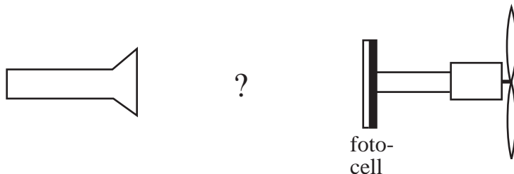
Figur 21.6 Experiment för funderingar om energiöverföring mellan ficklampa och fotocell.
