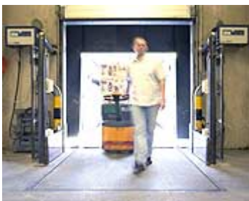
Figur 21 .Bilden visar hur en handtruck med RFID-försedda kartonger dras fram mellan två höga RFID-läsare vid en port till ett av Metros distributionslager. Källa: Metros internetsida.
