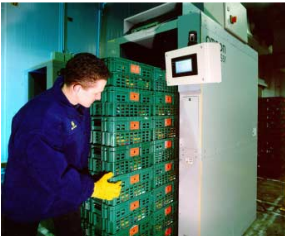
Figur 24. Bilden visar hur en mängd plastbackar utrustade med RFID-taggar körs genom en RFID-läsare för att läsas av gruppvis. Källa: Tibben&Brittens internetsida.
