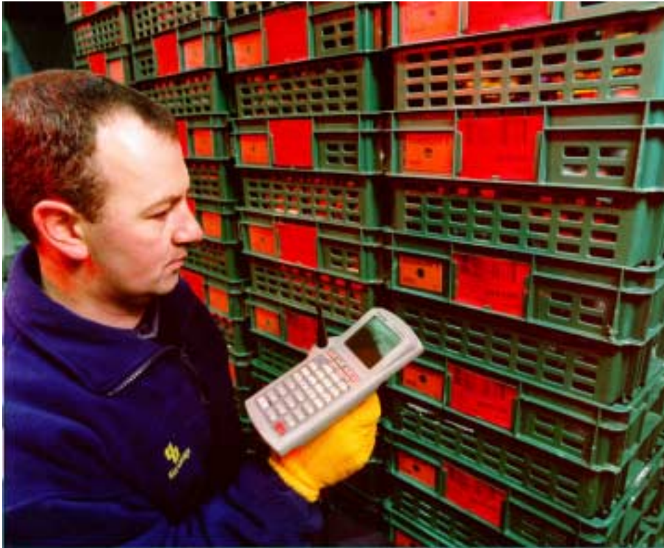
Figur 23. Bilden visar backar utrustade med både RFID-taggar och streckkoder och hur taggarna avläses genom en RFID-läsare. Källa: Tibben&Brittens internetsida.
