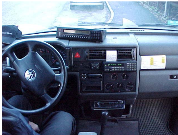
Bild 3. Förarmiljön med mobitexen överst på instrumentbrädan, taxametern i mitten med kombinerad skrivare där noden 5 skrivs ut.
