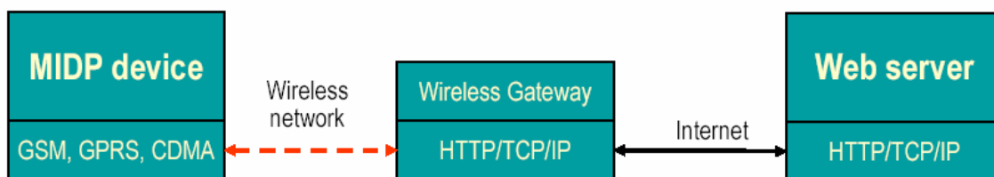
Figur 3 - Skiss som visar hur kommunikationen sker mellan MIDP och Web server
