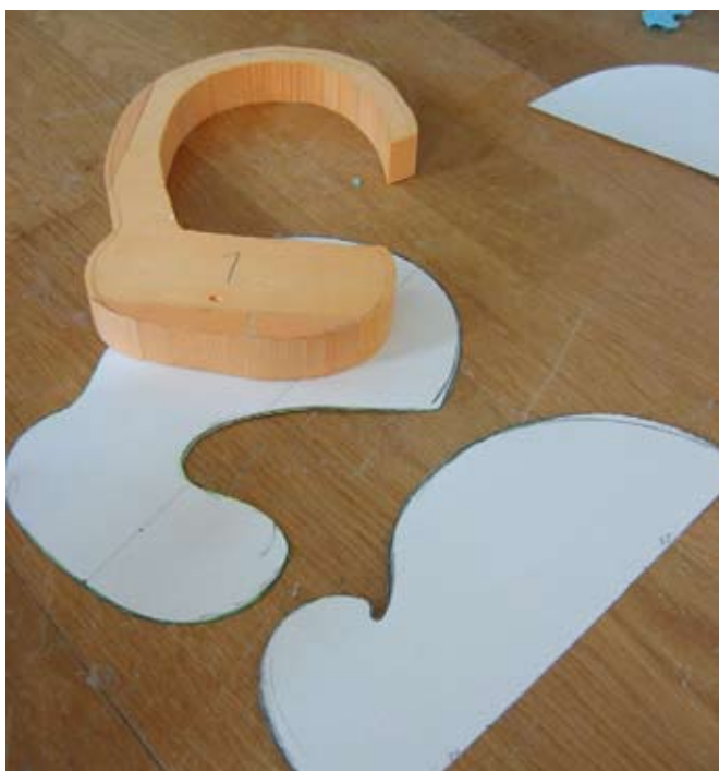
Ett block av Cibacol skivades upp i filéer efter vyskisser, för att hålrummet i kupan skulle kunna skapas. Skivorna limmades sedan ihop igen och formen slipades fram med hjälp av handfil.
