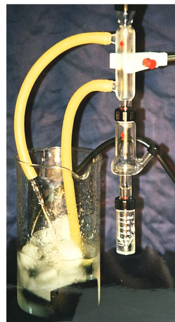
Figur 11. Småskalig destillation i vilken man recirkulerar kylvattnet
