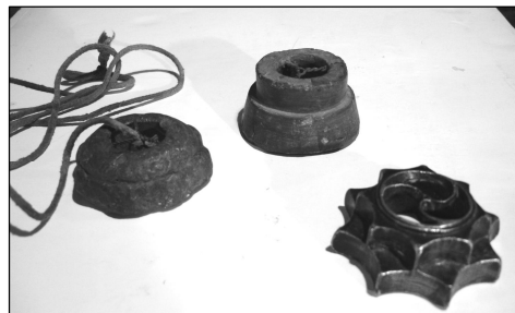
Figur 30: Forskellige typer af det traditionelle franske lod med det specielle hul
