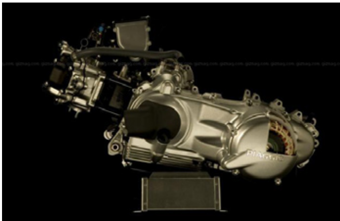
Piaggio hybrid motor, växlar mellan enbart el och bensin/el
