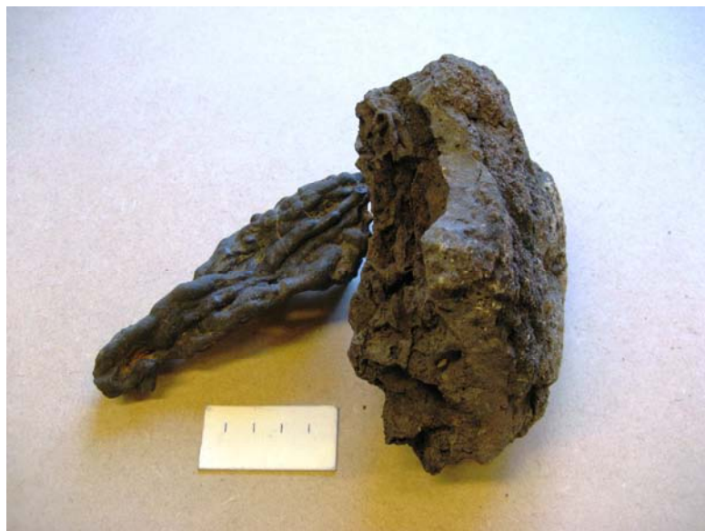
Fig. 56. Slagg och del av en ugnsvägg. Foto: Tina Fors.
