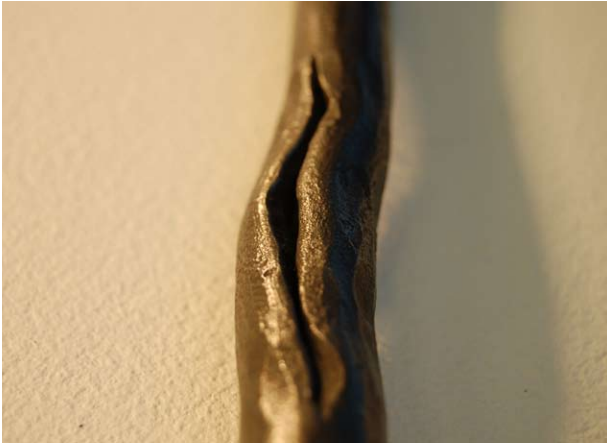
Bild nr. 3 Utgångsform, spricka
