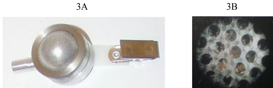
Figur 3. Button prøvetaker. Figur 3A viser kassetten og Figur 3B viser tetting av gitteret med melpartikler.
