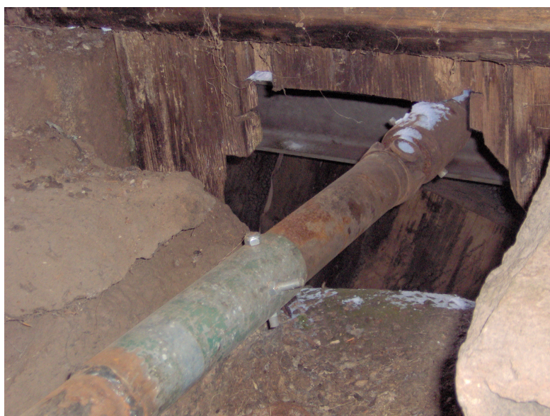
7. Vannhjulets horisontale hovedaksel sett innenifra og ut. Bilde Ø. Svenning
