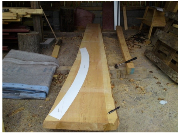
Figur 33 Påritning efter mall
