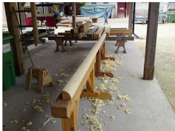
Figur 41 Först maskinhyvlad och sedan handhyvlad
