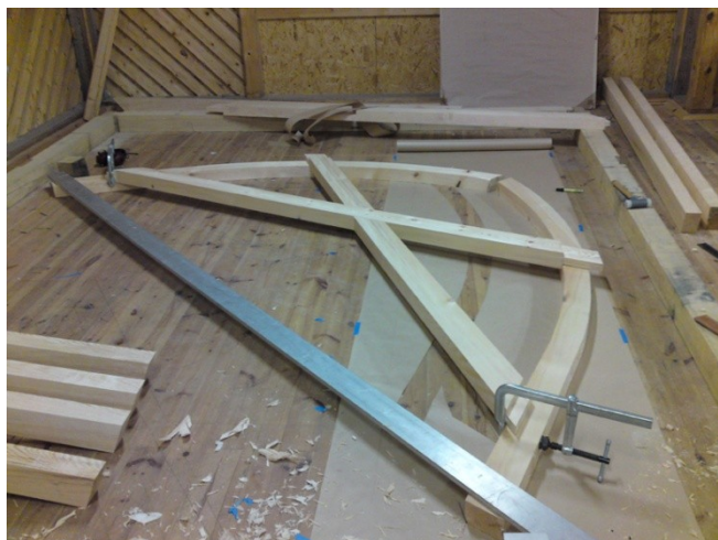
Figur 27 Sax med tappar som ger saxtakstol
