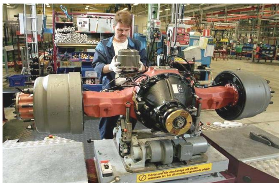
Bild 8 Huvudprodukten från Lindesbergfabriken: En bakaxel till en lastbil. 35
