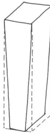
Figur 6. Kilformad huggning längs med liggytan och byggytan.
