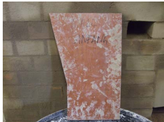
Figur 23. Vinkelmall för huggning av anfanget.
