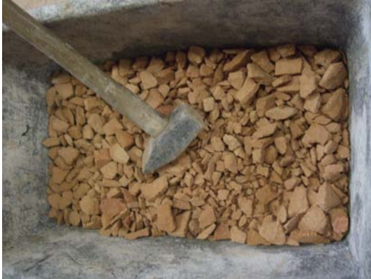
Figur 17. Svick som krossas till tegelgrus.
