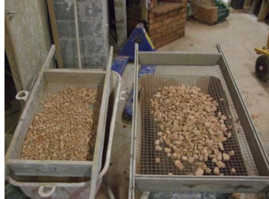
Figur 18. Sällning av tegelgrus för att avlägsna de större fraktionerna och tegelmjölet
