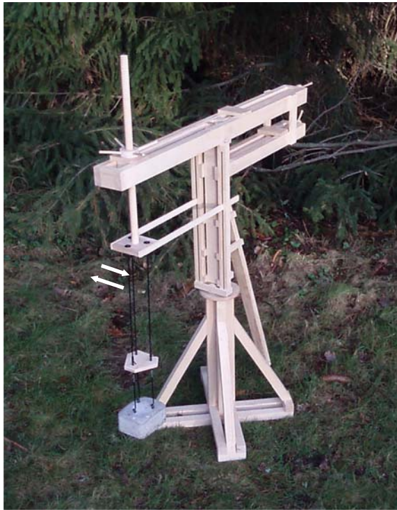
Bild 1. Pilarna visar horisontell rörelse orsakad av eventuell vindlast eller hastig rotation av kranen isin tur orsakad av operatören vid "rorkulden". Foto U Lidberg.
