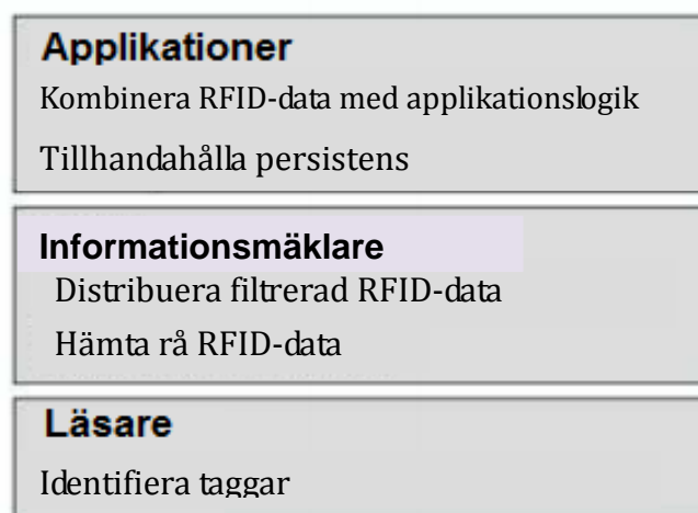
Figur 1 - Funktionella komponenter i ett RFID-system (Egen översättning) (Floerkemeier & Lampe, 2005, s.1)
