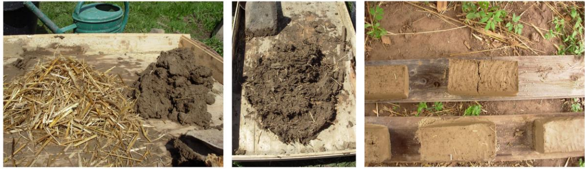
Ill. 27, 28, 29. 27: Klippt halm och lera, 28: Lera blandad med halm, 29: Färdiga stenar
