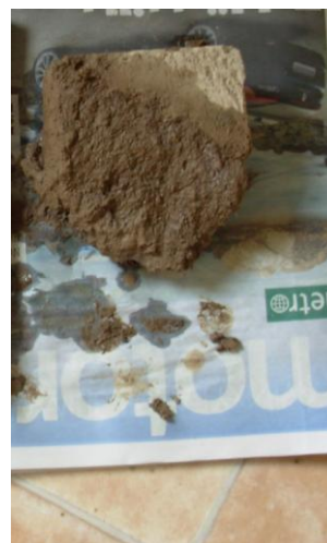
vattnets påverkan var mycket stor, nästan hela stenen var upplöst
