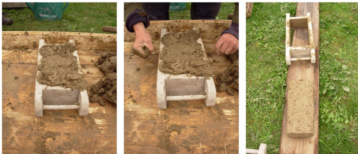
Ill. 24, 25, 26. 24: Lera slagen i form 25: Överflödiga lera skärs av med ståltråd, 26: Färdig sten på bräda
