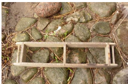
Ill. 2 Dubbelform för lerstenstillverkning
