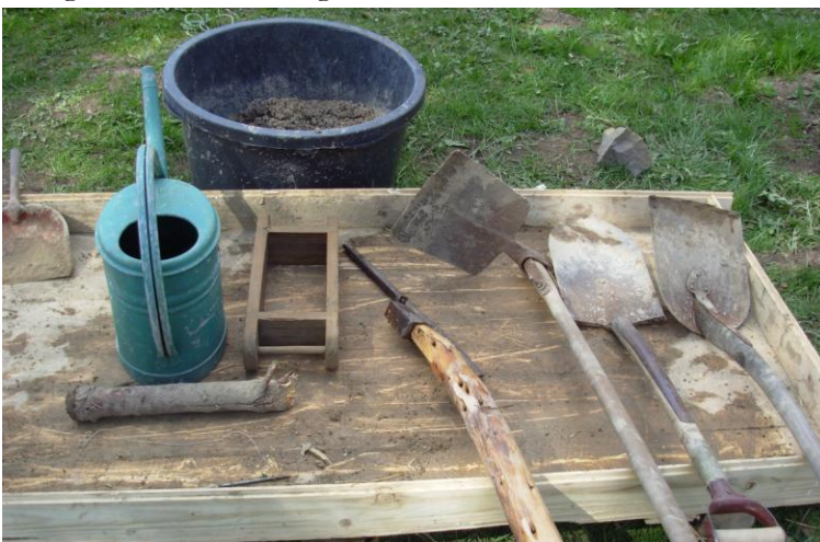
Ill. 30 Redskap som användes vid lerstenstillverkningen från höger till vänster: skyffel, spade, hacka, lerpiska, träform
