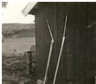
Ill. 3,4,5. 3: trähammare för att slå sönder gamla lerstenar 4: lerpiskor för ältning 5: lerslätta för att släta ut lerputs
