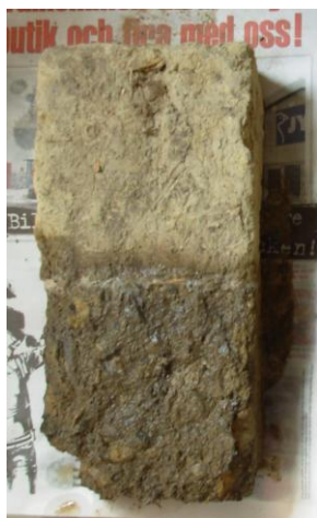
vattnets påverkan var mycket liten, låg uppsugning
