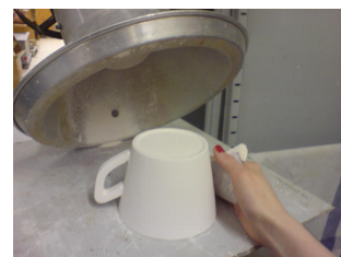
...örat gjuts i en tvärdelad form och sedan fäster man örat vid kärlet. Koppen torkas och bränns därefter. Sedan slipar man bort ojämnheter från koppen innan det är dags för glasering.
