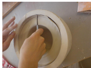
...i gjutformarna gjuter man porslinet. Ju tjockare porslin, desto längre får massan dra i formen. Sedan håller man bort överflödiga massa, porslinet får torka lite, därefter skär man bort leran så koppen får en skarp kant...
