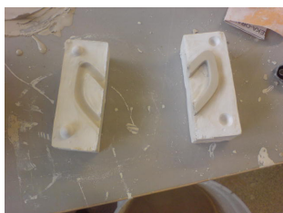
...örat gjuts i en tvärdelad form och sedan fäster man örat vid kärlet. Koppen torkas och bränns därefter. Sedan slipar man bort ojämnheter från koppen innan det är dags för glasering.
