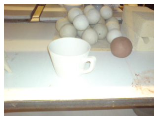
...örat gjuts i en tvärdelad form och sedan fäster man örat vid kärlet. Koppen torkas och bränns därefter. Sedan slipar man bort ojämnheter från koppen innan det är dags för glasering.
