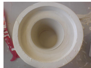
...i gjutformarna gjuter man porslinet. Ju tjockare porslin, desto längre får massan dra i formen. Sedan håller man bort överflödiga massa, porslinet får torka lite, därefter skär man bort leran så koppen får en skarp kant...
