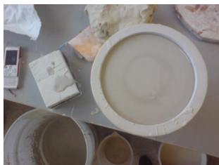
...i gjutformarna gjuter man porslinet. Ju tjockare porslin, desto längre får massan dra i formen. Sedan håller man bort överflödiga massa, porslinet får torka lite, därefter skär man bort leran så koppen får en skarp kant...
