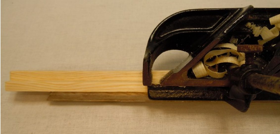
Figur 59 Falsen hyvlas med en falshyvel.
