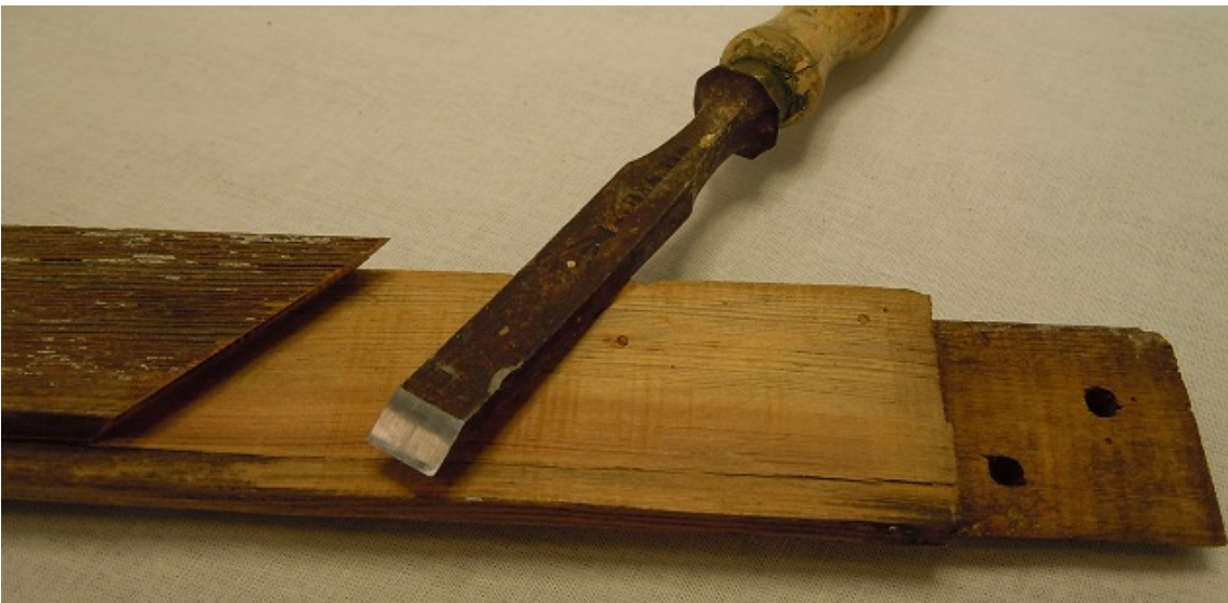
Figur 16 Limytan justeras med exempelvis en hyvel eller ett stämjärn.
