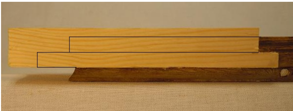
Figur 58 Lagningsträet med övermått på längden.
