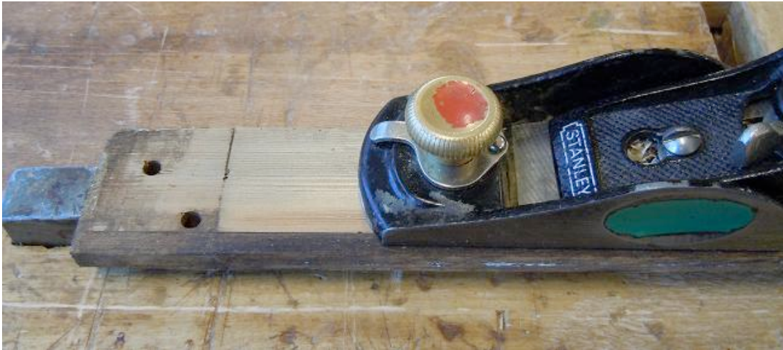
Figur 24 Limytan justeras med hyvel.
