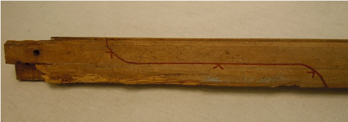
Figur 41 Skarven utritad efter skadebild och med tillräcklig längd på limytan längs fibrerna.
