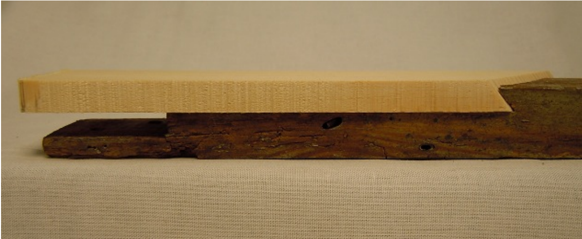
Figur 15 Ny bit tillpassas med övermått på ca 4-5 mm.
