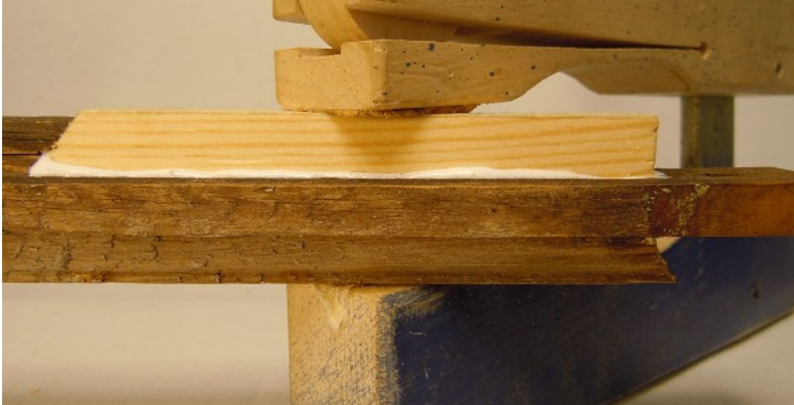
Figur 37 Lagningsbiten limmad och satt i press.
