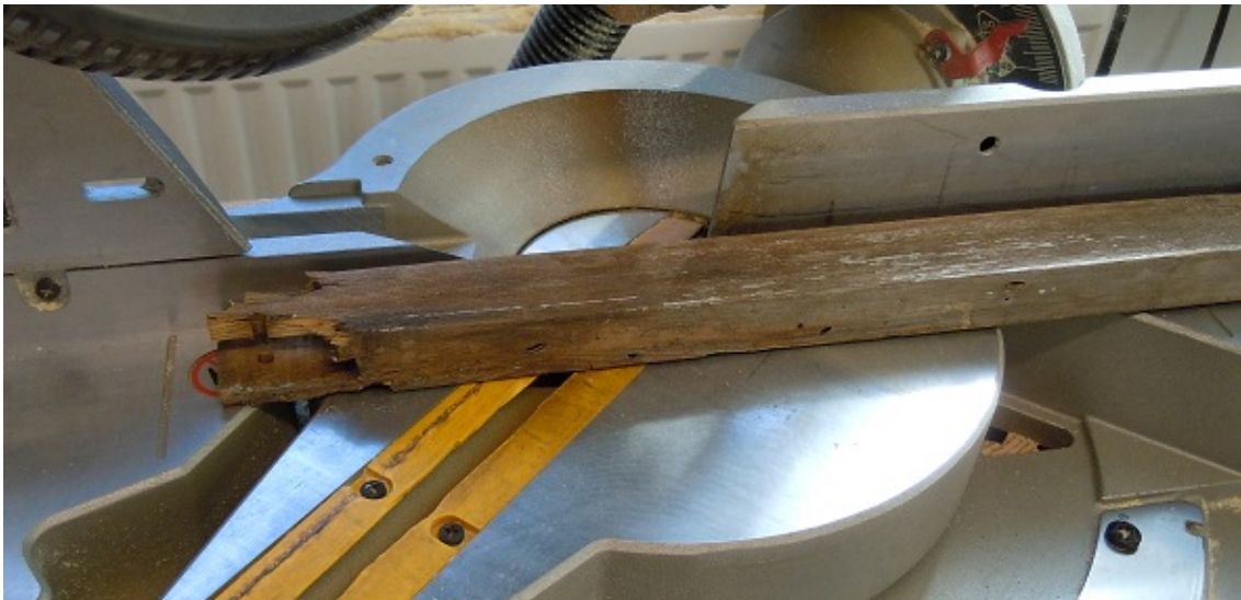
Figur 62 Bågdelen i geringssågen. Sågbord inställt på 45 grader och klingan på 30 grader.
