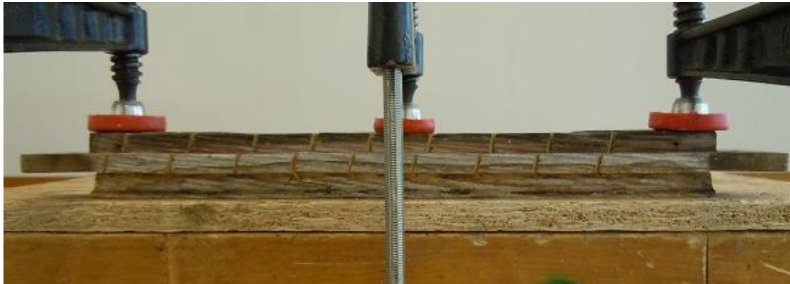
Figur 80 Bågstycket i press mot plant underlag.
