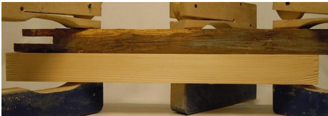
Figur 47 Det nya träet fixeras ovan eller under bågdelen som ska lagas.
