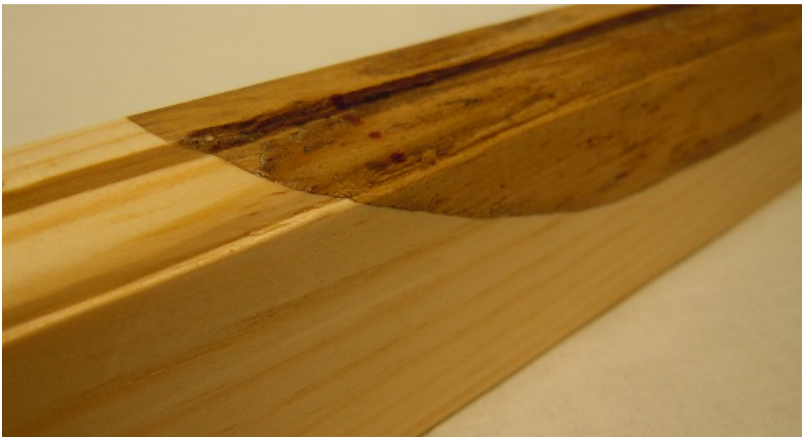
Figur 45 S-skarven justerad och klar. Här ses innersidans profilering.
