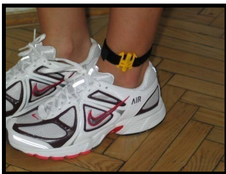
Bild 15: RFID-taggar används till tidtagning vid löpevenemang (Källa: Budapestmarathon, 2011)
