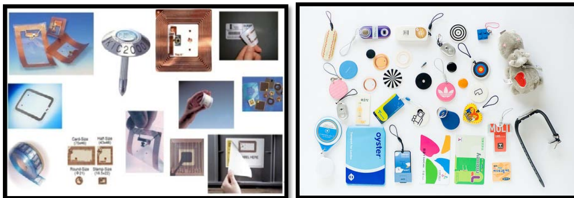
Bild 6 & 7: Olika typer av RFID-taggar (Källor: Jesic, 2008 och Flickr, 2007).
