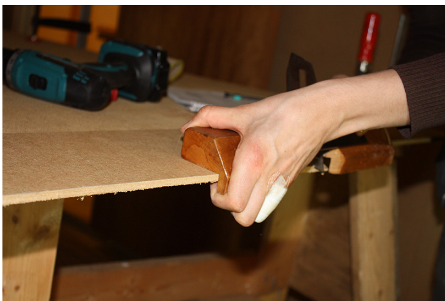
Fig. 52. Tråhyveln med metalldetaljer fungerade inte alls. Den ville inte arbeta sig ner i materialet. Jag upplevde det som att det fattades delar på den. Resultatet i samtliga skivor blev ungefär som provhyvlingen i torra skivor (se fig. 44). Se fig. 26-28, Bilaga 3. Foto: Linda Andersson.
