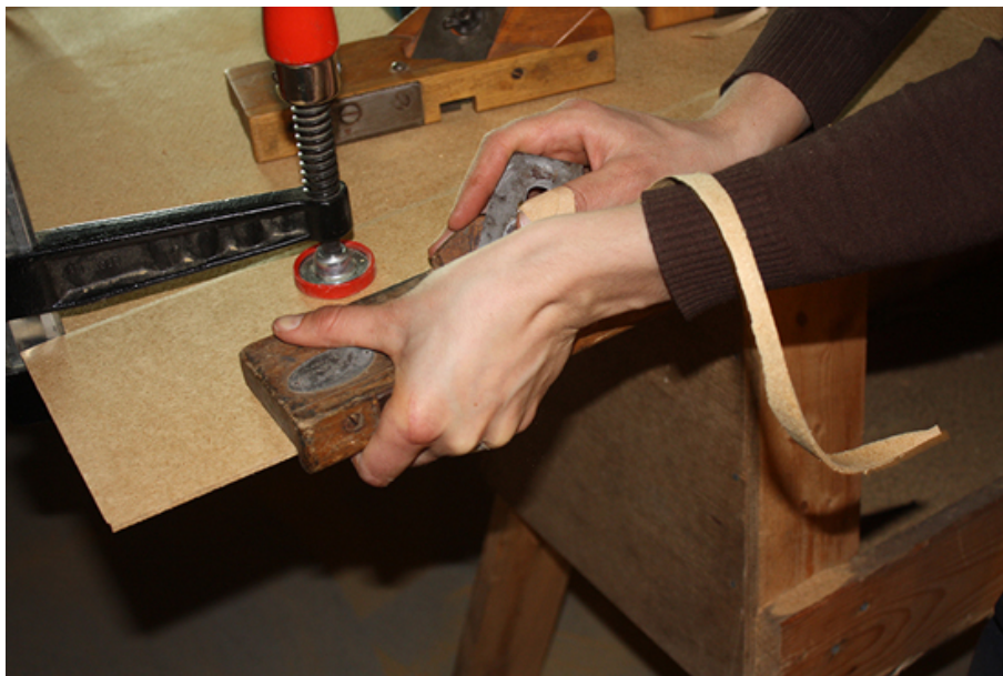
Fig. 60. Fashyveln med pat. nr. 112 475 erbjöd ett bekvämt handgrepp som gjorde att handen kom nära skivan. Jag föredrog att skjuta den framför mig, men samtliga kunskapsbärarna har använt den genom att dra den bakåt. Den fungerade bäst på både våta och torra skivor när den ställdes om mellan hyveltagen och tog lite åt gången. Se fig. 14-17, Bilaga 3. Foto: Linda Andersson.
