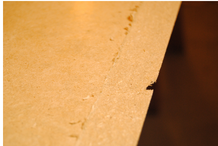
Fig. 64. Om handen vickade lite p.g.a. att anhållet inte var anpassat efter tjockleken på skivan kunde det bli hack i kanten med fashyveln med pat. nr. 112 475 . Leif Grundström tipsade om att vicka på handen, men det bör ha berott på att han var van vid sin egen hyvel och visste exakt hur anhållet var inställt. Se avsnitt 2.3.8.
