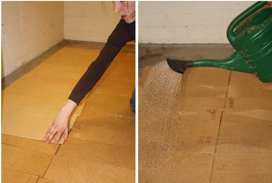
Fig. 41. Provbitar sågades upp inför provhyvlingen av de 9 masonithyvlarna. Vattnet fördelades med vattenkanna med stril och ströks ut med handen eftersom en piassavakvast hade spridit ut dem. Bitarna lades direkt på källargolvet i en ruta som täckte ca 120 x 240 cm. Samtliga skivor fick för mycket vatten enligt Jan Perssons rekommendationer.
