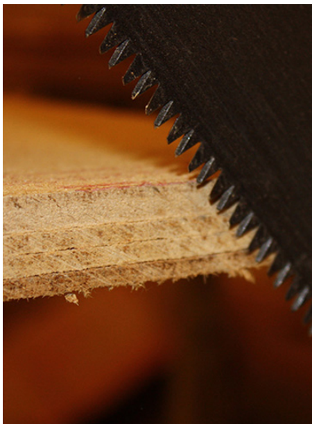
Fig. 65. Vänster: Fogsvansen gör urslag på undersidan eftersom trycket främst går neråt. Höger: Cirkelsågen gör urslag på översidan eftersom klingan roterar medsols mot en, d.v.s. uppåt.
