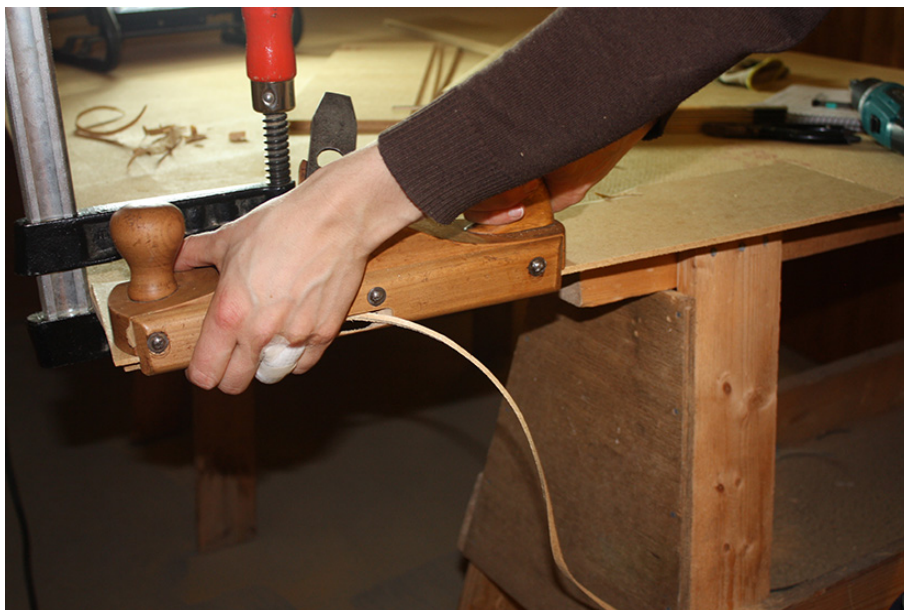
Fig. 50. Fashyveln i trä för synliga/öppna fogar fungerade i princip varannan gång då inte spånet kilades fast intill hyvelstålet. Spåret i anhållet för skivan var olika högt så att en 6,4 mm skiva fick plats i början av anhållet men inte i slutet. Se fig. 23-25, Bilaga 3. Foto: Linda Andersson.
