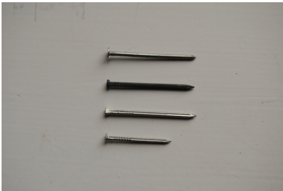
Fig. 83. De fyra typerna av spik som undersöktes. Uppifrån: Gammal fiberplattspik 35 x 1,7 mm; gammal varmförzinkad dyckert 35 x 1,7 mm; ny elförzinkad dyckert 35 x 1,7 mm; ny elförzinkad dyckert 25 x 1,4 mm. Samtliga spikar fungerade bra. Men den korta var svårare att hålla i och oljehärdade skivor var hårdare och spikarna kröktes lättare.
