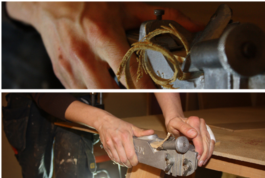
Fig. 57. Frånstahyveln fanns i tre exemplar med några mekaniska skillnader sinsemellan. Det speglar antagligen en produktutveckling över tid. Se fig. 11-13, Bilaga 3 för skillnaderna. Exemplet med hjulet fungerade sämst eftersom den inte fjädrade när tjockleken på skivan ställts in. Frånstahyveln åstadkommer både synlig och dold fasning beroende på hur stålet vinklas. Överst: Synlig/öppen fog. Nederst: Dold omlottskarv (fungerade inte på 6,4 mm för att stålet inte gick att ställa så djupt, Se fig. 8, pil 4, Bilaga 3. ) Foto: Linda Andersson.
