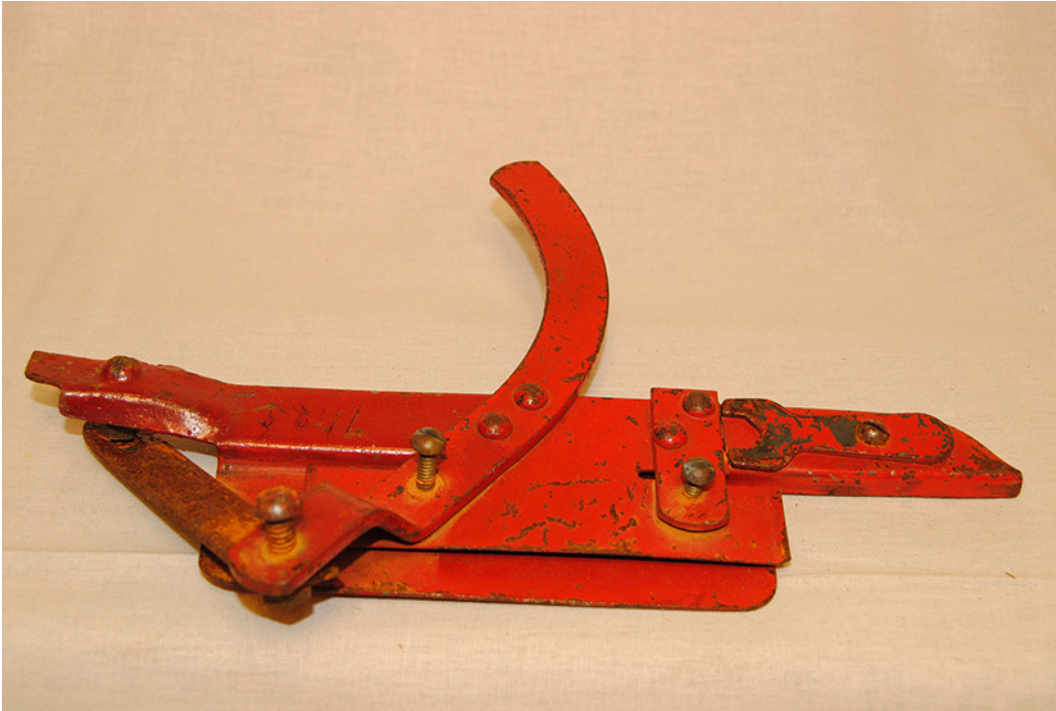
fig. 21. En av de röda metallhyvlarna var ganska medfaren av rost och hade stålet vänt med eggfasen uppåt.
