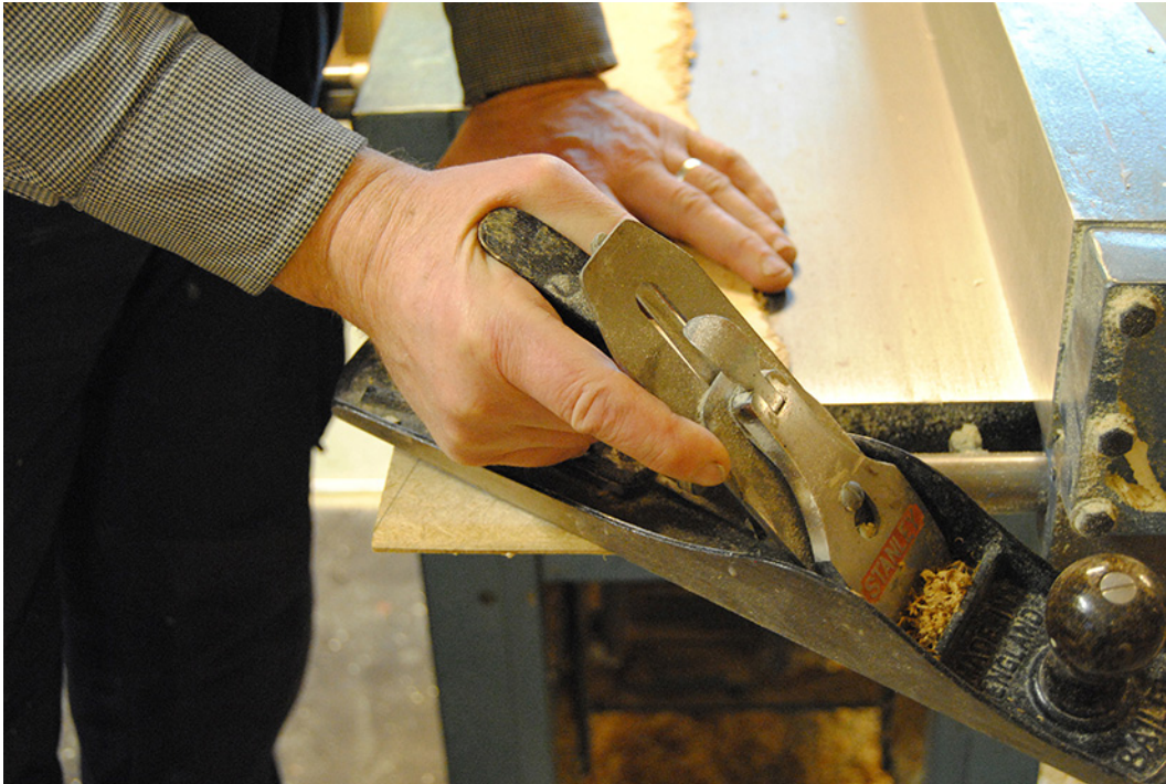
Fig. 20. När Leif Grundström skulle göra synliga fasningar för spackling använde han putshyvel. Bilden är tagen vid intervjun 2011-02-25.
