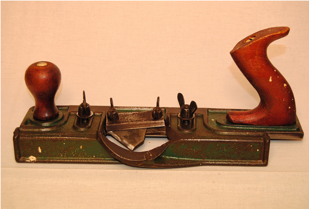
fig. 7. Resultat efter slipning av stål, metalldetaljer och putsning med linolja och våtslappor med kornstorlek 600 eller 1200.
