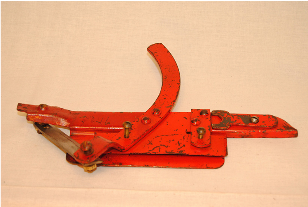
fig. 22. Resultat efter slipning av stål, metalldetaljer och putsning med linolja och våtslappapper med kornstorlek 600 eller 1200.
