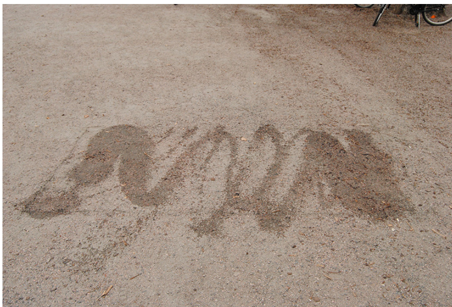
Fig. 40. Den första provbevattningen gjordes på en ruta i gruset utomhus. Den var i samma storlek som en skiva, d.v.s. ca 120 x 240 cm. Som kan utläsas av mönstret var det inte lätt att fördela vattnet jämnt med vattenkanna.
