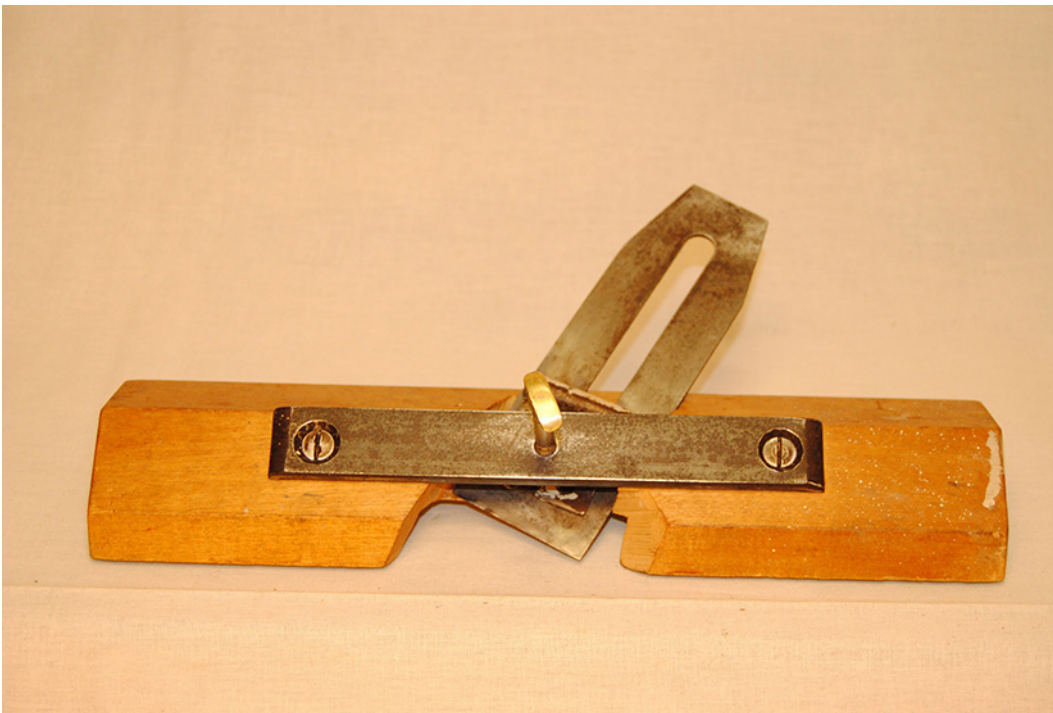
fig. 27. Resultat efter slipning av stål, metalldetaljer och putsning med linolja och våtslappapper med kornstorlek 600 eller 1200.
