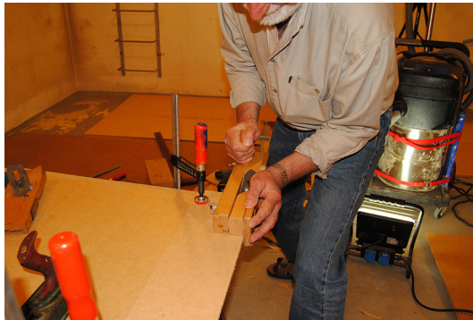
Fig. 59. Masonite-hyveln var extremt trög att hyvla med och kunde inte ställas in så att den avverkade lite i taget. Se fig. 1-3, Bilaga 3. Bild tagen under workshopen med Bengt-Arne Cramby 2011-05-09.
