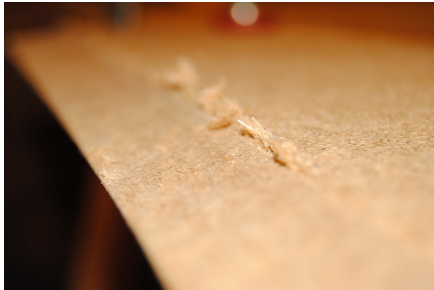
Fig. 63. Om stålet ställdes för djupt med fashyveln med pat. nr. 112 475 arbetade stålet som en falshyvel istället så att kanten blev fnasig. Se figur 16, pil 4, Bilaga 3.
