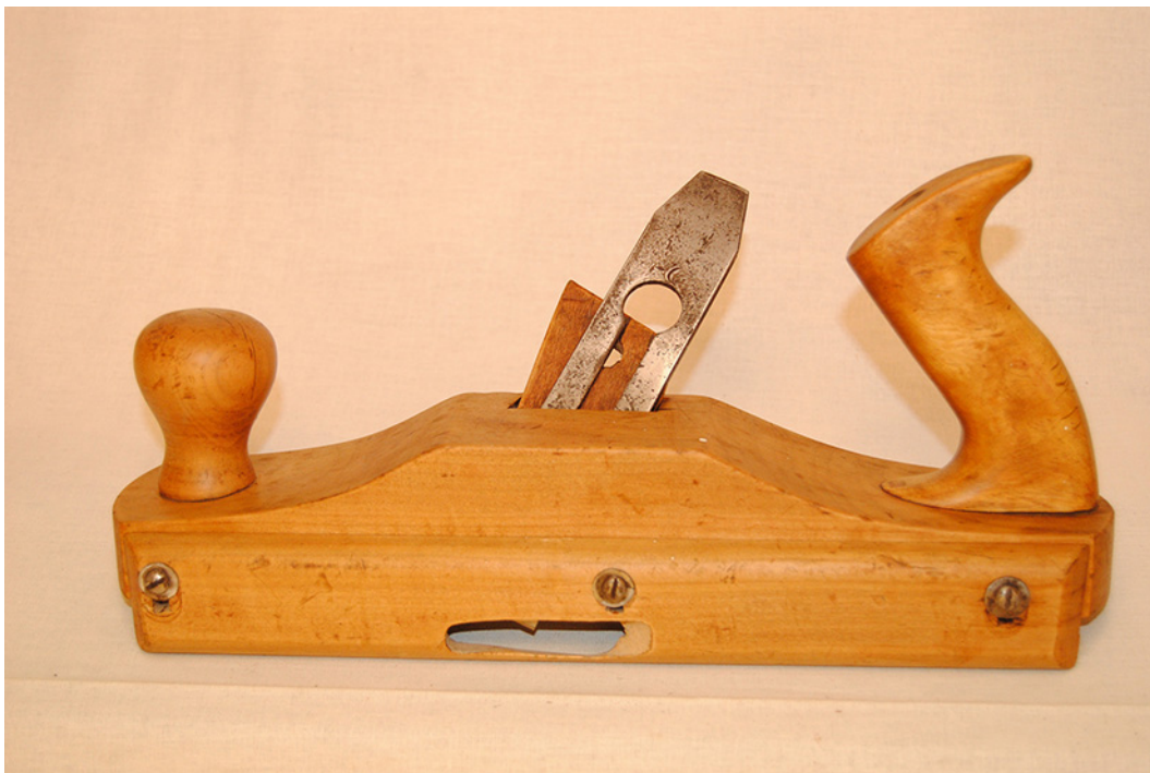
fig. 24. Resultat efter slipning av stål, metall detaljer och putsning med linolja och våtslippapper med kornstorlek 600 eller 1200.
