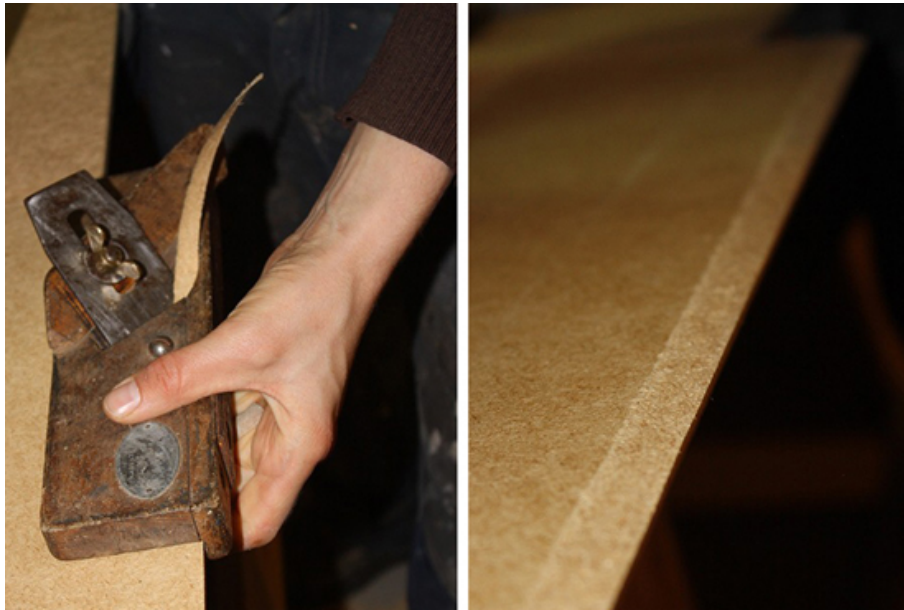
Fig. 61. Vänster: Bilden visar hur spånet kommer upp i spånöppningen på fashyveln med pat. nr. 112 475. Höger: Bilden visar det färdiga resultatet av hyvlingen. Foto: Linda Andersson.
