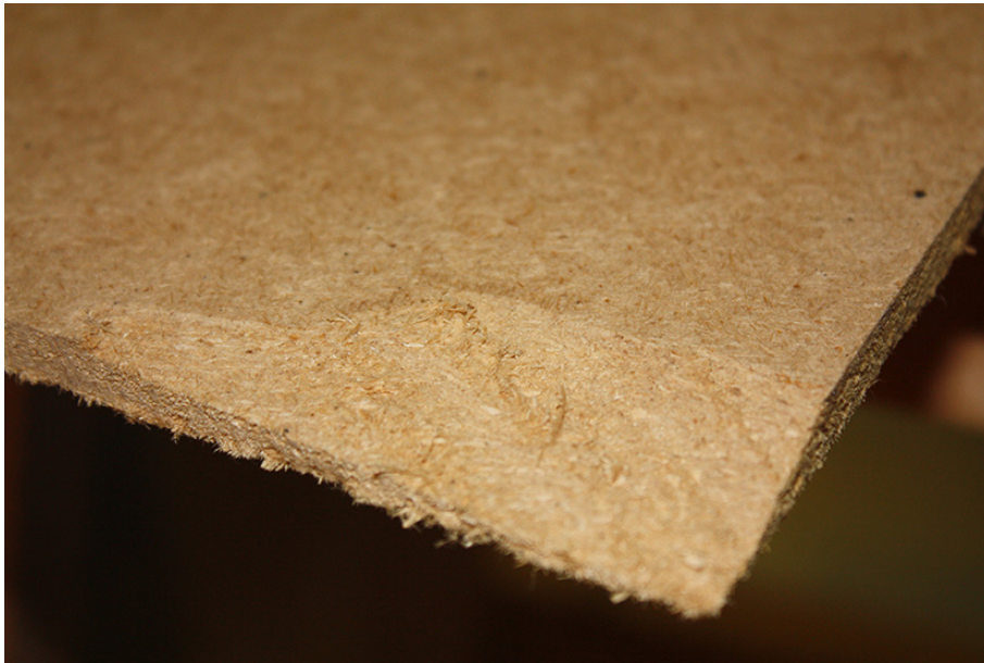
Fig. 44. I torra skivor var det svårt att få hyvlarna för dold fog att avverka. Det gick utomordentligt trögt när allt material skulle tas i ett hyveltag. Med fashyvel pat. nr. 112 475 fungerade det med flera hyveltag. Se fig. 14-17, Bilaga 3. Foto: Linda Andersson.
