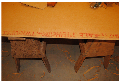
Fig. 54. Kanten blev vågig mellan stöden eftersom Ljusnehyveln inte hade något anhåll på undersidan. Se fig. 6, Bilaga 3. Bild tagen under workshopen med Bengt-Arne Cramby 2011-05-09.
