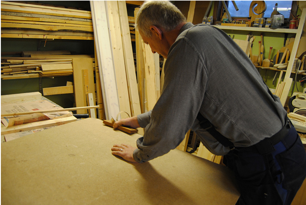
Fig. 19. Leif Grundström använde fashyveln med pat. nr. 112 475 genom att hyvla bakåt på liggande skivor. Bilden är tagen vid intervjun 2011-02-25.
