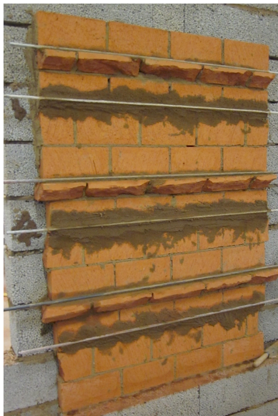
Fig. 2. Testväggens tre hyllsektioner, förberedda med gejdrar och släpor.
