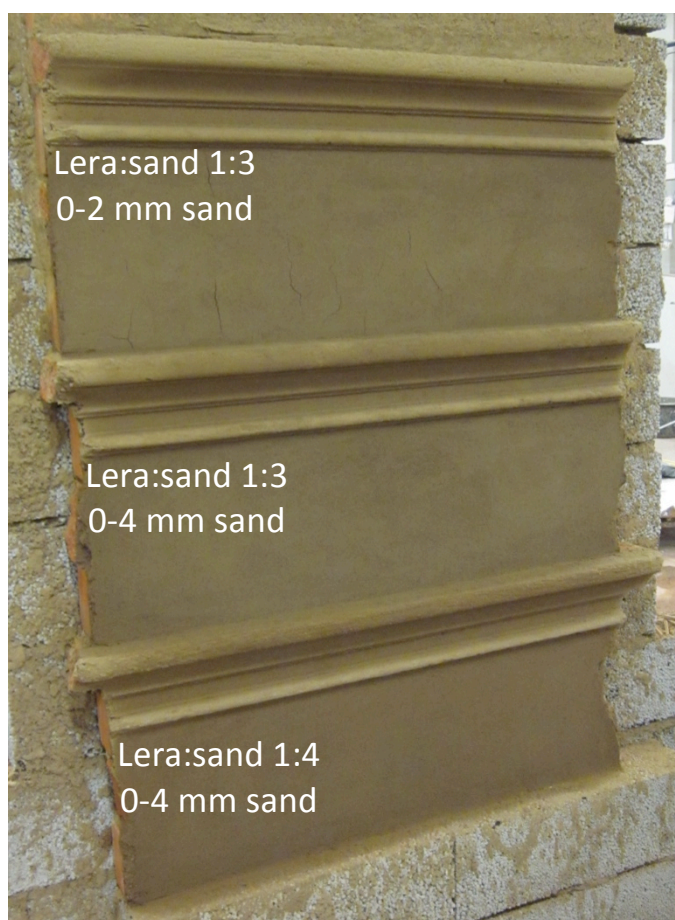
Fig. 4. Tre färdigdragna lerbrukslister.
