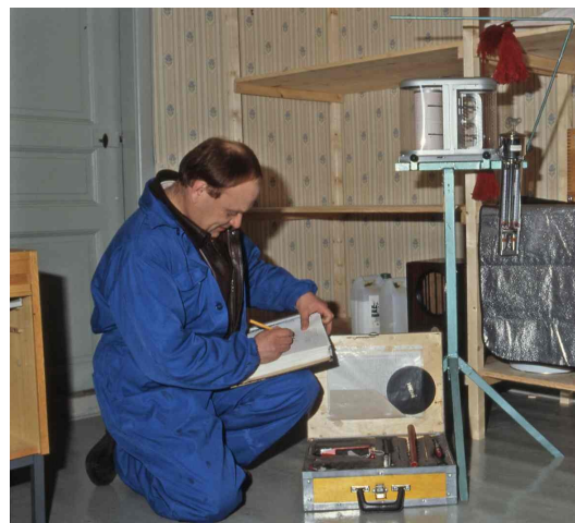
fig 3: Ingemar Johansson för protokoll vid klimatomätning, specialställning för termohygrograf användes, foto Sigfrid Carlsson
