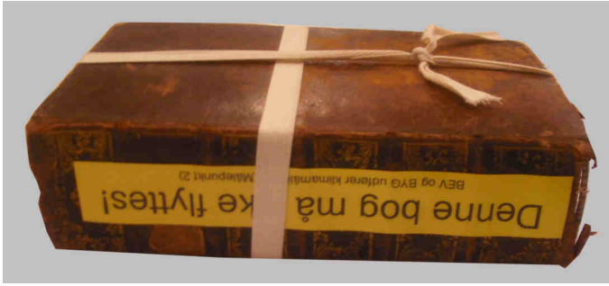
Figur 9 viser forsøgsopstillingen under det første delforsøg. Bog_{data\ logger1} er udhulet som vist i Figur 8. Bog_{data\ logger1} holdes lukket under forsøget med en snor. Foto af Signe Smedemark.
