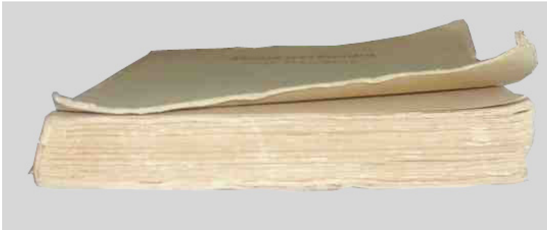
Figur 18 e viser papirbindet anvendt under forsøget beskrevet i afsnit 6.1.1 efter tre udtagninger fra køleskab til stuetemperatur. Foto Signe Smedemark.
