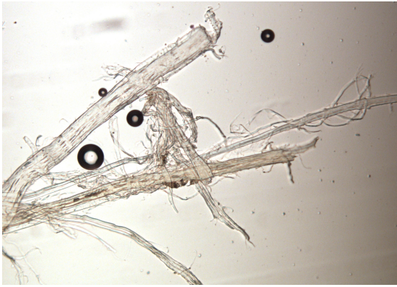
Fig. 8. Fibrer i Graff C Stain lösning, ljusmikroskop 125 x förstoring.
