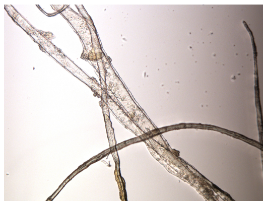
Fig. 3. Bild tagen i ljusmikroskop i 125 x förstoring, kōzo-fibrer från objekt 1.
