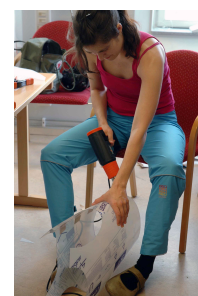
Fig. 13. Therese Hultman värmer och formar polykarbonat. 2010 Foto: Anna Ehn Lundgren
