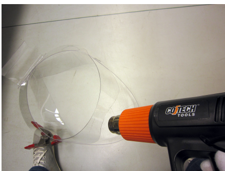
Fig. 49. Kanter på monteringen rundas med värmepistol. 2011 Foto: Anna Stålbring
