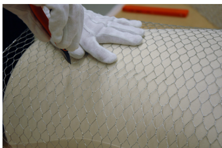
Fig. 21. Nät formas genom att maskor vrids till med tång. 2010 Foto: Anna Ehn Lundgren
