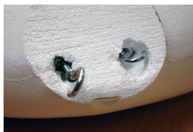
Fig. 9. Montering av takfästen i frigolittorso. 2010 Foto: Anna Stålbring
