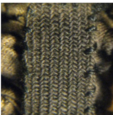
Figur 26: Spännband till den övre och den undre turnyrskenan. Bandet är maskinflätat vilket gör det mer elastiskt än ett vävt band. I ändarna sitter hyskor och hakar.
