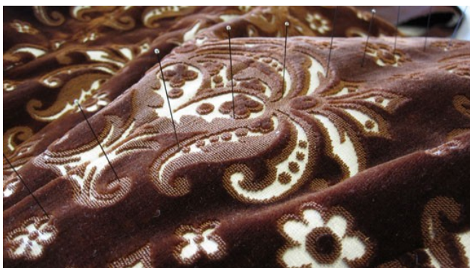
Figur 2: Insektsnålar användes för att markera punkter längs en trådrak linje vilka sedan användes som utgångspunkt vid mätning
