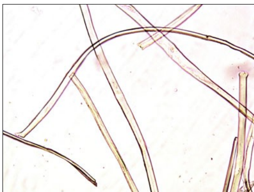
Figur 7: Varpen i den ljusblå satinväven. Släta relativt jämna fibrer med mindre ojämnheter tyder på silke.
