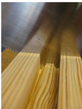
Figur 128 Spröjsen med profilen uppåt sågas.
