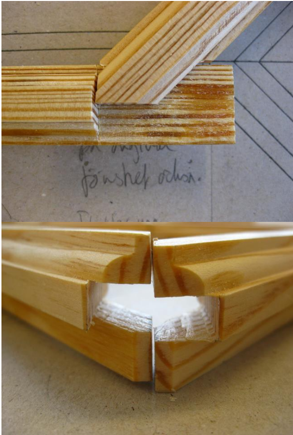
Figur 192 Med hjälp av en tappmall i rätt dimension testas slitsens tröghet.
