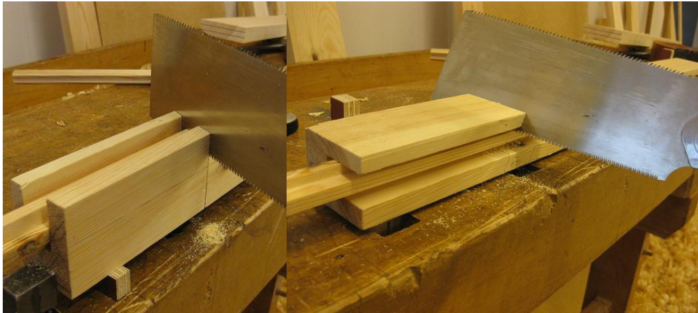
Figur 131 En spröjs med falsidan upp. Figur 132 Sågsnittet fortsätter ner längs gerlådans sida.
