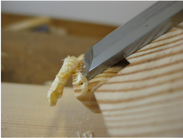
Figur 187 Spröjsänden tåls rent med stämjärn.
