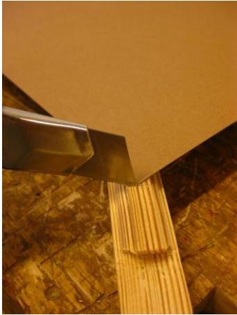
Figur 151 Med en kniv markeras mallen hörn på kryssset.
