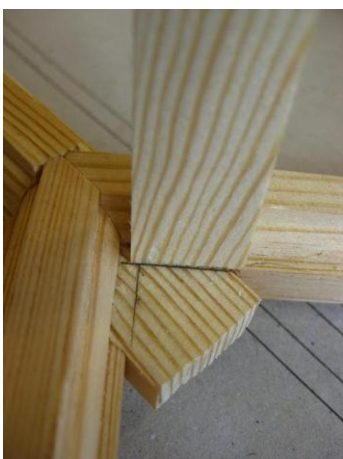
Figur 197 Markeringar görs med en tunn list som mall.
