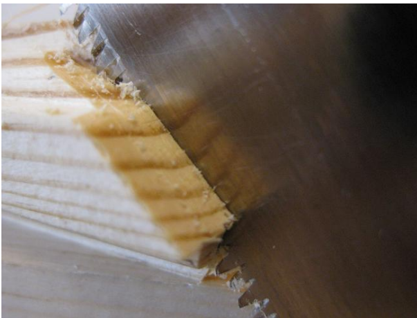
Figur 183 Kontraprofilens djup sågas efter geringssnittet.
