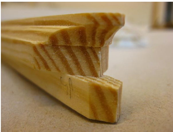
Figur 163 Färdigt spröjsmöte med täljd kontraprofil.
