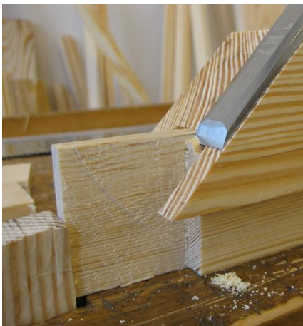
Figur 116 Bågstycke geras för kontraprofilering.
