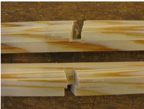
Figur 134 Halvt i halvt sammanfogningen utan gering sett från sidan.
