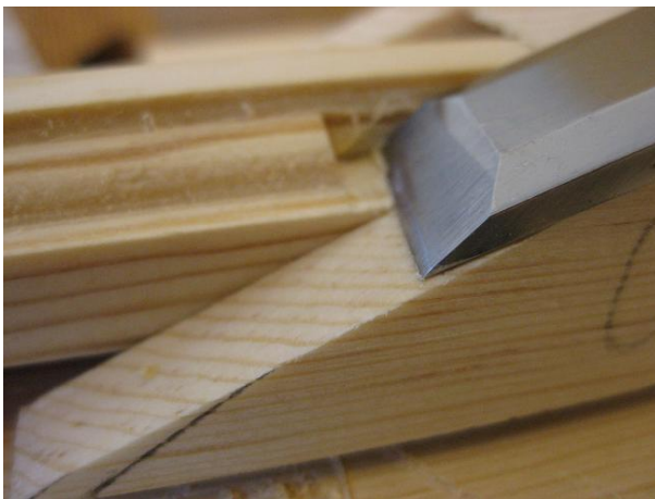
Figur 180 Fibrerna har buggits av och geringsnittet görs.
