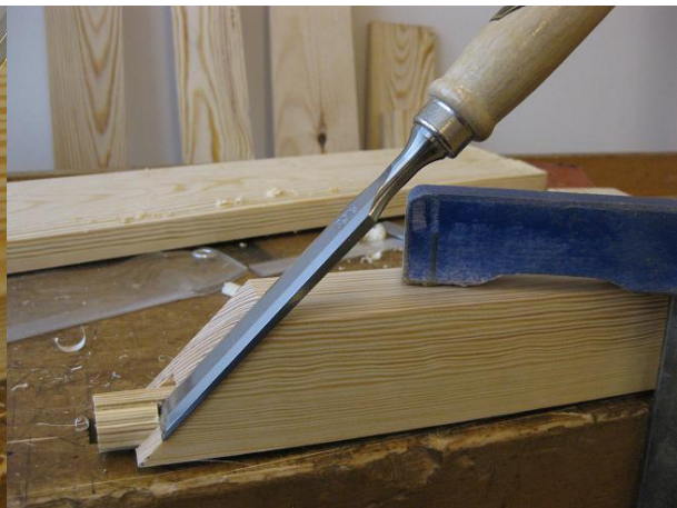
Figur 117 Spröjs geras för kontraprofilering.
