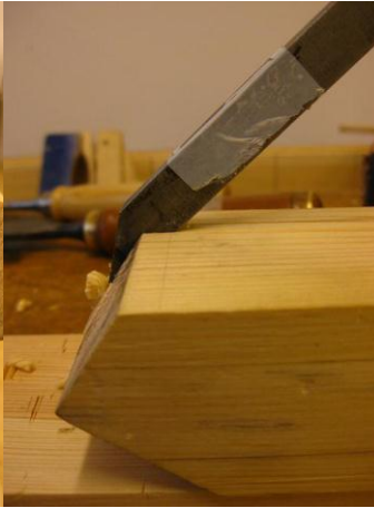
Figur 155 Spåren skärs till med hjälp av jiggen
