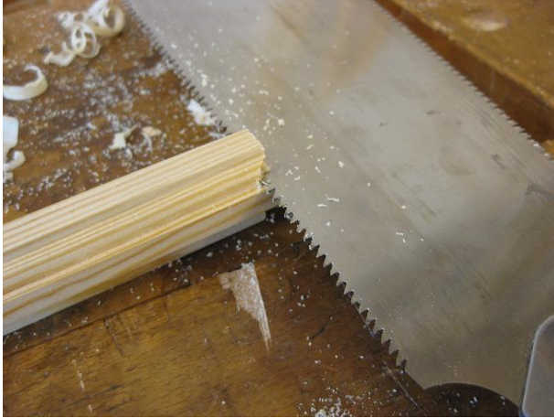
Figur 118 Ett sågsnitt sågas för kontraprofilens djup.
