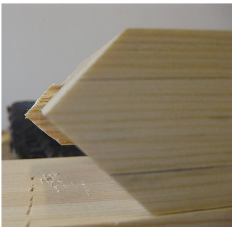
Figur 186 Spröjsen i jiggen efter att överslottsmaterialet sågats bort.
