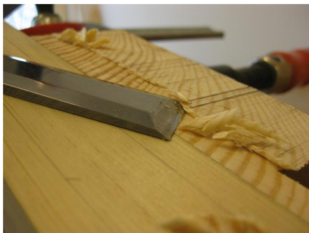
Figur 125 Jiggens anläggningsyta renskärs med stämjärn.
