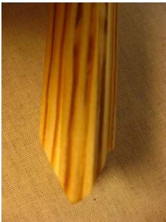
Figur 162 Efter gering sett ovanifrån.
