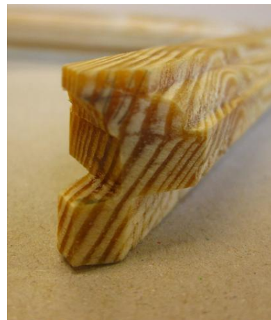
Figur 164 Färdigt möte med en plan yta.
