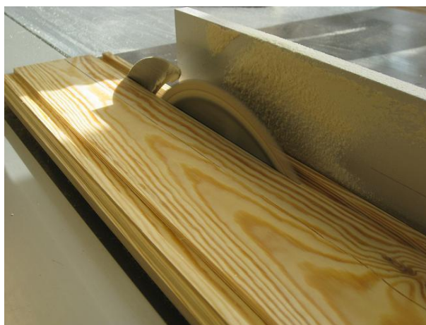
Figur 102 Spröjsen sågas loss från brädan.
