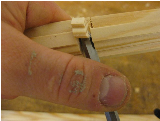
Figur 133 Överskottsmaterial skärs bort.
