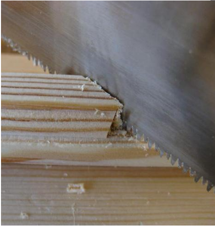
Figur 181 Såga ner mot tappen. Här syns den ena geringen som gjorts innan sågning.
