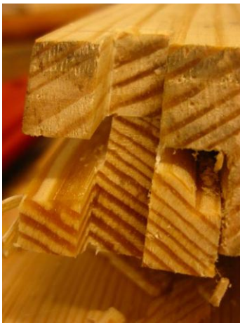
Figur 157 Spåret i spröjsens ände.
