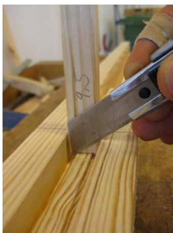
Figur 129 Listen placeras intill sågsnittet för att markera var man skall ritsa.
