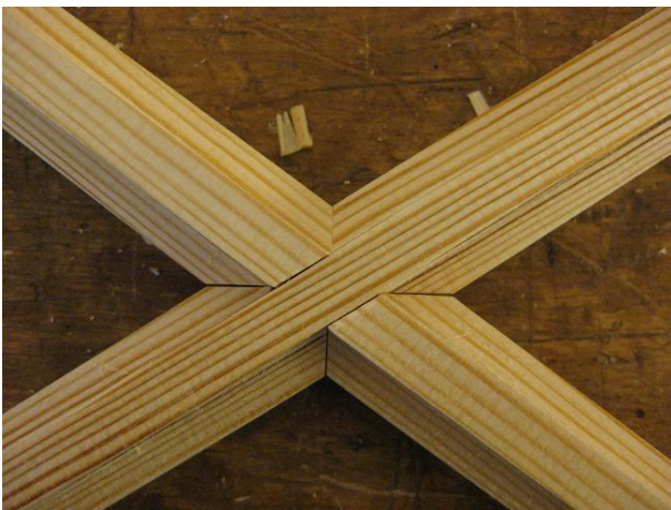
Figur 141 Diagonalkryss sett från falssidan.
