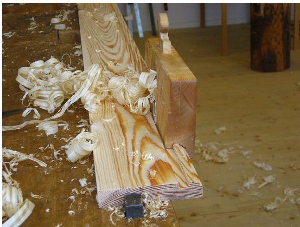
Figur 98 Spröjs hyvlas med en spröjshyvel.
