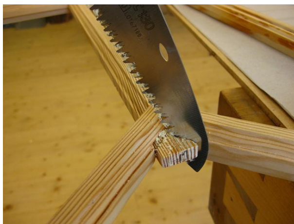
Figur 198 Tappen sågas efter markeringarna.
