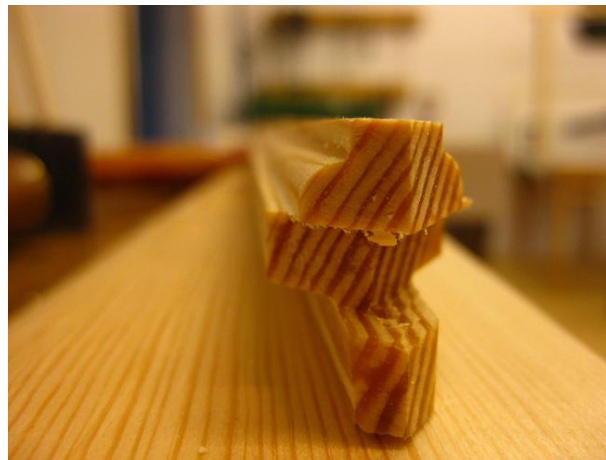
Figur 158 Vinklarna och spåret som tillverkas med jiggen.
