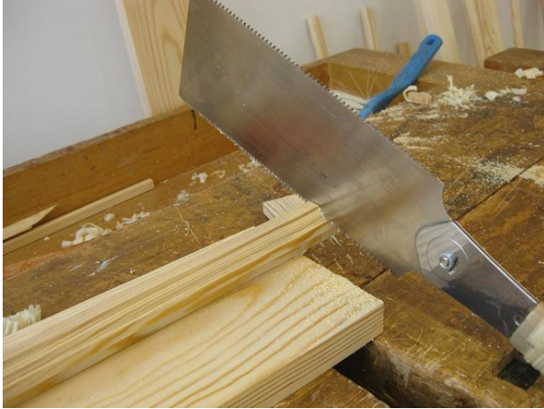
Figur 112 Snittet ner mot plattan sågas i spröjsen.
