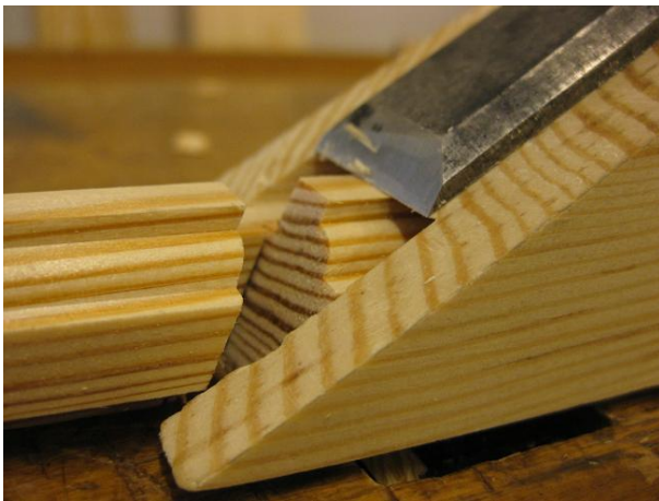
Figur 137 Jiggens anläggningsyta placeras i skärningspunkten för spröjsryggens hörn.
