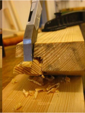
Figur 156 Spår under tillverkning.
