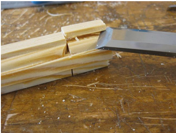
Figur 114 Överskottsmaterial "sprücks" bort med stämjärn.
