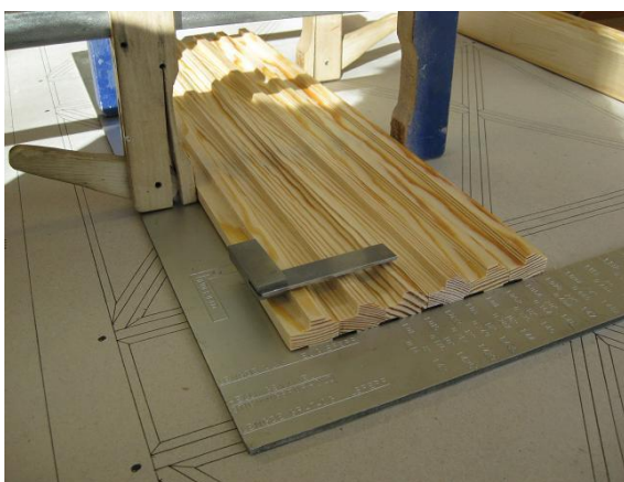
Figur 106 Spröjsen hålls ihop med tvingar och alla mått förs över på samma gång med hjälp av en anslagsvinkel.
