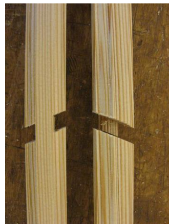
Figur 135 Halvt i halvt sammanfogningen utan gering sett uppifrån.
