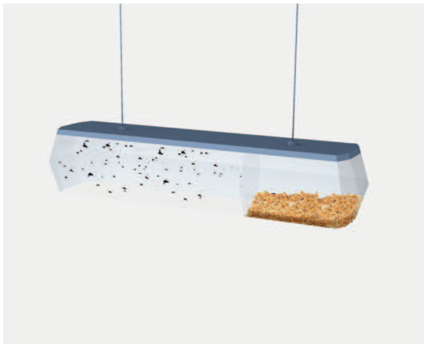
Insektsfarm för privat bruk. 1200 x 250 x 350 mm. Glasbur, belysning och klimatkontroll. Egen skiss.
