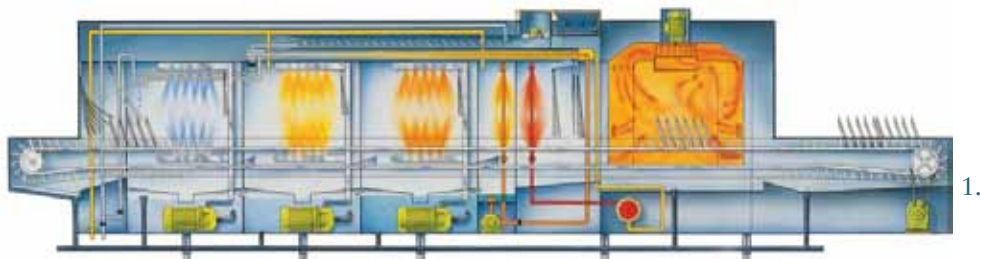
Bild 6.13 Innområdet på en industridiskmaskin. Detta är i grunden detsamma som i en banddiskmaskin.
