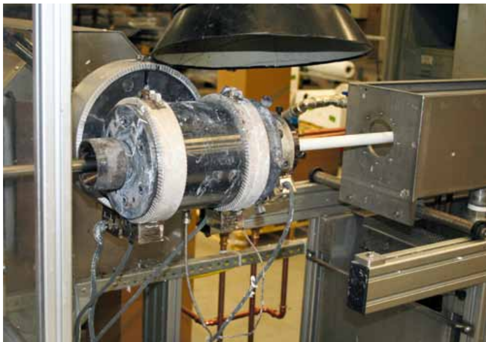
Bild 5.14 Ett stålrör plastbeläggs. Till vänster på bilden syns det råa stålröret och till höger kommer det ut ett vitt plastbelagt stålrör
