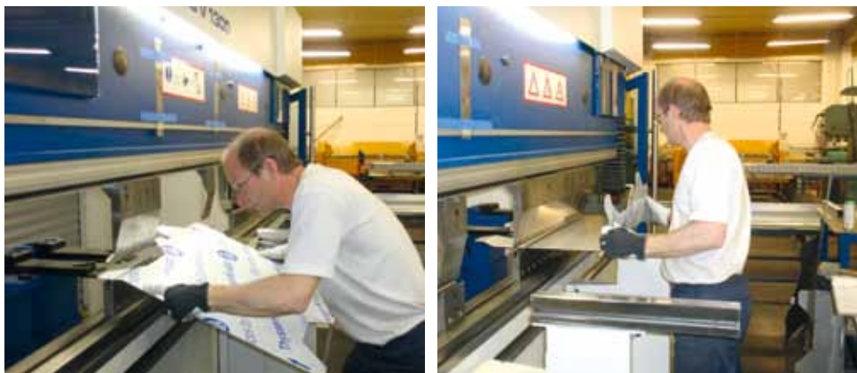
Bild 4.7 och bild 4.8: Magnus Karlsson knäcker grundplåten till Duniformmaskinen
