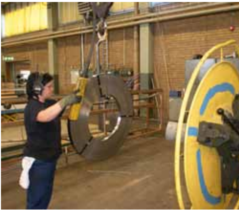
Bild 5.7 och 5.8: Linda Andersson byter bandstålsrulle på den lilla valsmaskinen
