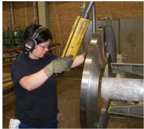
Bild 5.7 och 5.8: Linda Andersson byter bandstålsrulle på den lilla valsmaskinen
