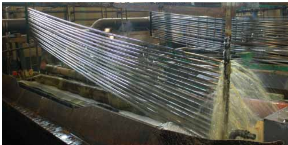
Bild 5.11 och bild 5.12: Jon fäster stålrör på väg in i ytbehandlingen; Stålrören lyfts upp ur nickelbassängen
