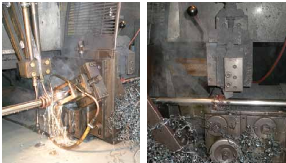
Bild 5.9 och 5.10: Stålröret svetsas ihop i skarven; Svetskanten slipas bort
