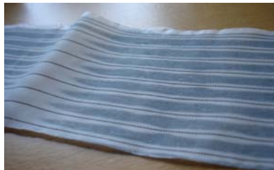
1. Textil som utvecklar värme när man lägger på en spänning.
