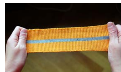
Projekt 5. Virtuell rehabilitering med smart textiles. En töjkänslig textil består av ett ledande material där de ledande partiklarna »dras isär« när man töjer i materialet. Ledningsförmågan blir då sämre, dvs. resistansen i materialet ökar och man kan genom att mäta resistansen i materialet se hur om och hur mycket det töjs.
