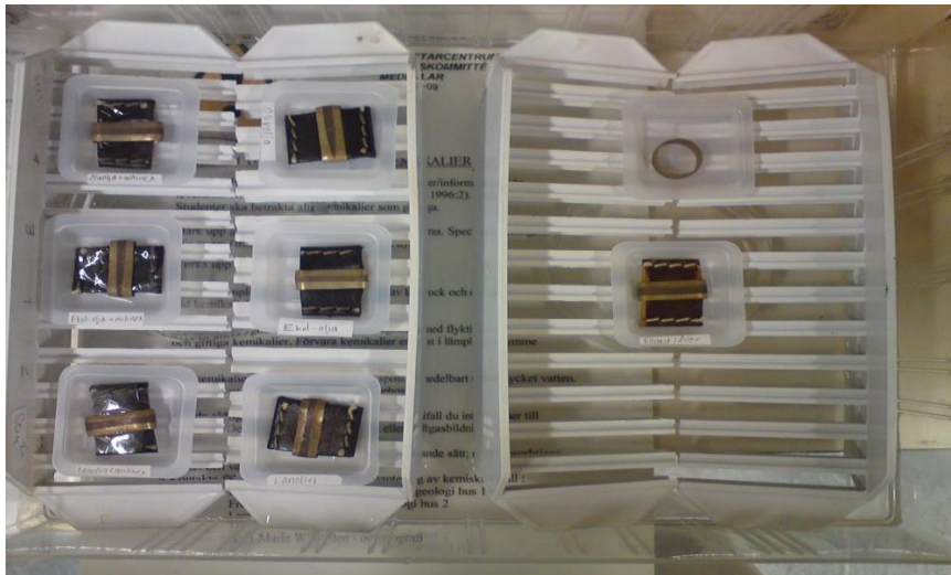
Figur 7 Åtta prover bereddes och placerades i klimatkammare under fyra veckor. De två till höger är referensprov. De tre ytterst till vänster har Melinex som isolering mellan mässingen och lädret.
