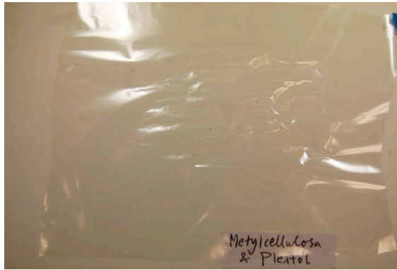
Figur 17. Metylcellulosa med Plextol D360
