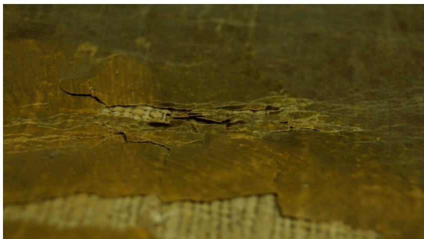
Figur 5. Exempel på skört och fragmenterat papper. Materialet ramlar lätt sönder vid hantering. Skadan är orsakad av att objektet legat hopvikt.
