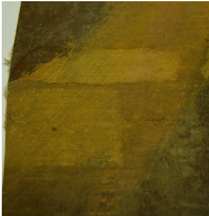
Figur 6. I den övre rutan är fernissan avlägsnad. Den undre är rengjord med vatten.
