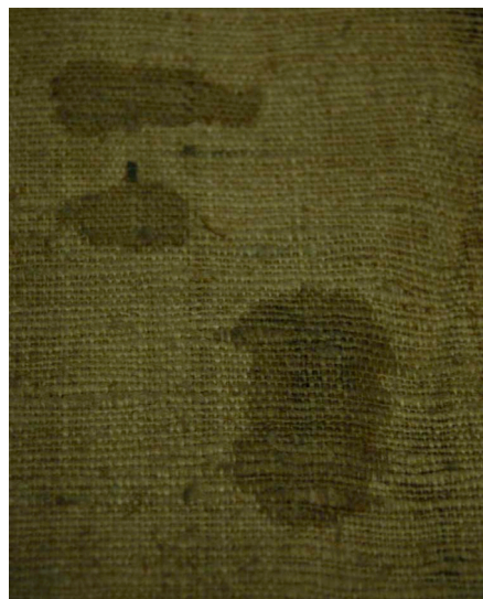
Figur 14. Missfärgning orsakad av MFK
