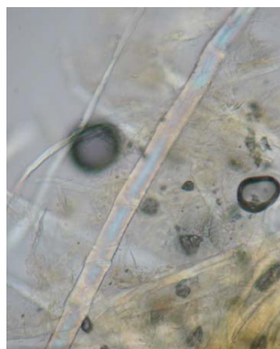
Figur 2. Papprets fibrer i mikroskop
