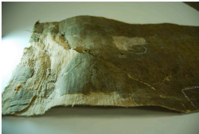
Figur 12. Pappret limmat med stärkelse i nederkant. Deformationer har uppkommit där materialet fått torka fritt.
