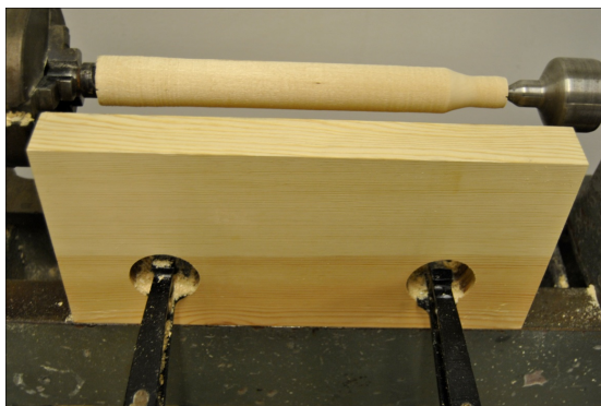
Figur 28. För att få exakt rätt dimension på skruvämnet kan ett anhåll användas tillsammans med en fastsatt kloss på svarvstålet. Här har en vinkelrät träbit satts fast i svarven med tvingar. Anhållet ska vara så högt att svarvstålets egg hamnar ovanför ämnets centrum då det vilar på anhållet. Anhållet måste justeras så att det är parallellt med skruvämnet.
