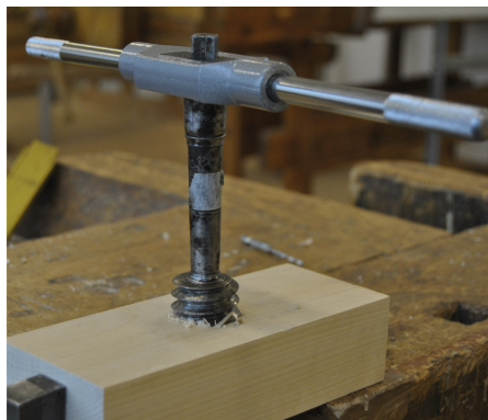
Figur 31. Gängtappen behöver dras runt med någon form av handtag i metall eller trä.
