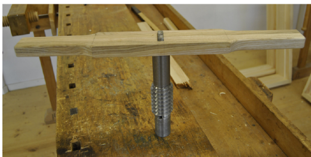
Figur 32. Det är viktigt att göra urtaget för gängtappens ände tvärs fibrerna, så att handtaget håller.
