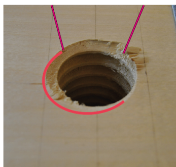
Figur 33. Material innanför linjerna måste tas bort.
