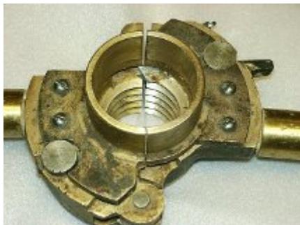
Figur 5. Snedtyg av den sort som idag används på Mårlilla Hyvelbänkar. Snedtygen i mässing köptes in någon gång under 1960-talet från en mekanisk verkstad. Foto: Leif Karlsson
