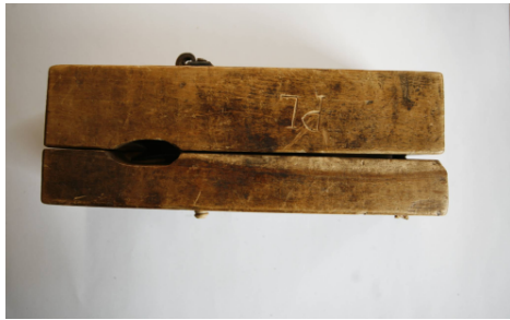
Figur 3. Äldre snedtyg är i regel rektangulära och saknar handtag. Snedtyget på bilden har tillhört snickaren Jon Jonsen Sørgård i Bardu kommun, i Troms fylke i Norge. Jon Jonsen Sørgård levde mellan 1798 och 1865 och var snickare och smed. Foto: Roald Renmælmo
