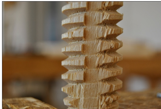
Figur 24. Skruv med ojämn gängvall.
