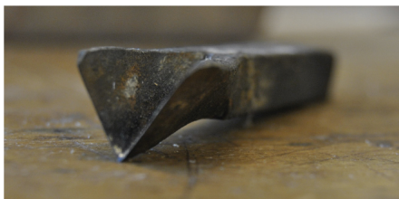
Figur 35 Det äldre stålet, oslipat
