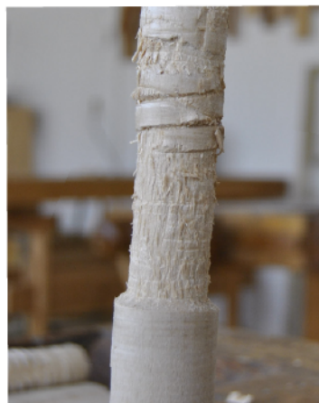
Figur 23. Resultatet då skruvämnets diameter är för stor.
