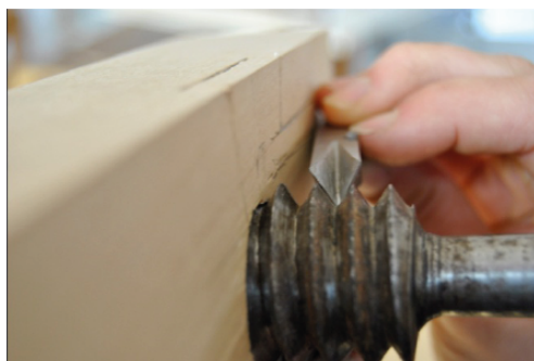
Figur 39. Stålet passas in mot gängtappens gänga.
