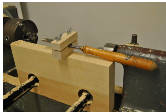
Figur 29. På svarvstålets över- och undersida kläms en kloss fast med vingmuttrar. Klossen justeras noga för att nå en exakt inställning som ger den önskade diameter på skruvämnet
