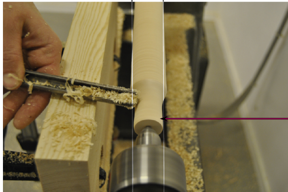
Figur 30. Pilen visar den ”styrning” som Börje Karlsson brukar svarva till på sina skruvämnen.
