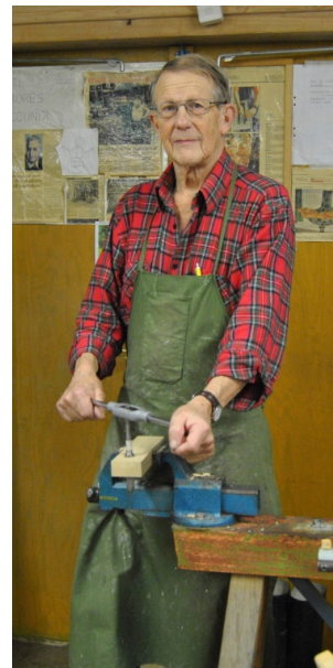
Figur 2. Snickaren Börje Karlsson tillverkar invändiga gängor. Foto: Niklas Alexandersson
