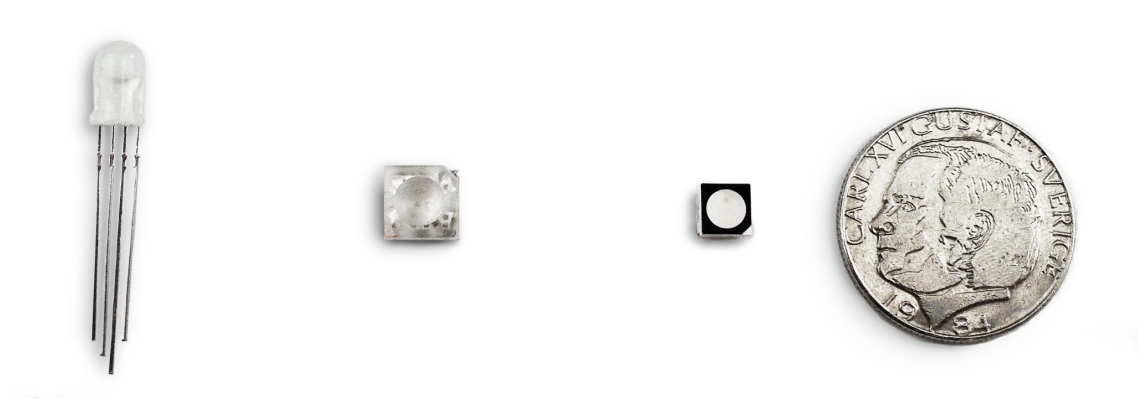
Figur 10: De två till vänster är hålmonterade modeller medan den högra är en ytmonterad variant.
