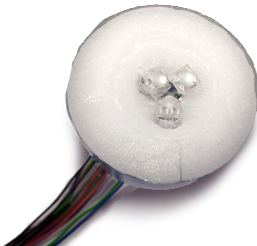
Figur 12: Den andra konstruktionen med tre RGB-lysdioder.
