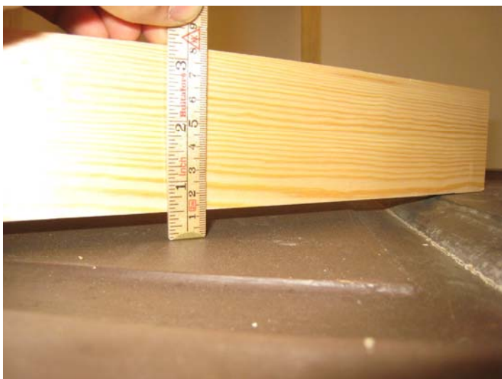
Figur 14 Mätning av höjdskillnad mellan ramverk och spegel.
