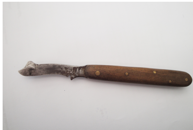
Figur 19. Okuleringskniv med barklösare som en puckel på ovansidan av knivbladet (modell TINA 641).
