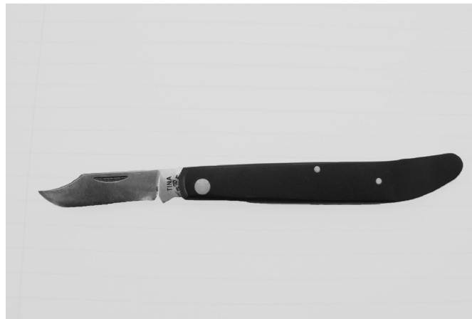
Figur 18. Okuleringskniv med barklösare längst bak på knivskaftet (modell TINA 650).
