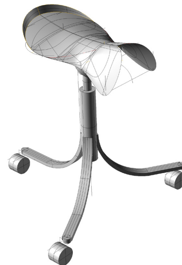
Tidig 3D-skiss, plattjärn i fjäderstål med radie. Möjlighet att sprida ut spänstigheten. Rhinoceros-rendering: Carl Wästfelt
