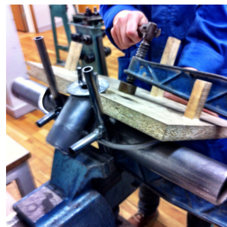
Spakformning med ett speciellt framtaget verktyg för ändamålet. Foto: Carl Wästfelt
