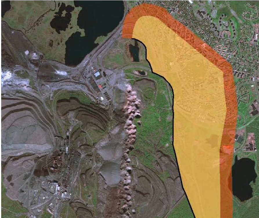
Figur 4, gult fält visar markdeformationer i Kiruna, när malmen är bruten på nivå 1 345 m. Orange fält visar skillnaden mellan största och minsta beräknade deformation 29 .
