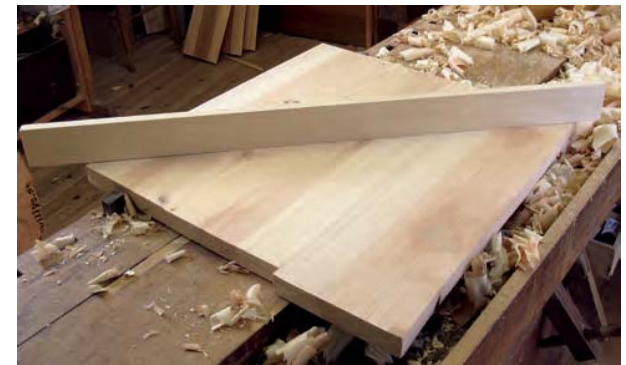
Bild 187. Kontroll med riktribba diagonalt över stycket.
