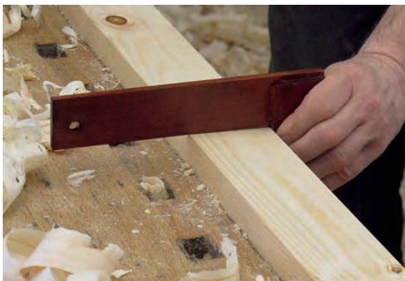
Bild 213. Vinkeln kontrolleras under hyvlingen av breddmättet.
