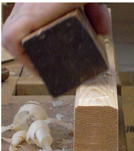
Bild 134 Stycket fasas ned till ritsen A vid hyvlingen av bredd- och tjockleksmåten, B och C .
