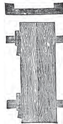
Bild 108. Kiltving. Ur Handbok i träslöjd (Carlsson 1911:35) och limknekt av trä. Ur Träslöjd (Hallen & Nordendahl 1923:44).
