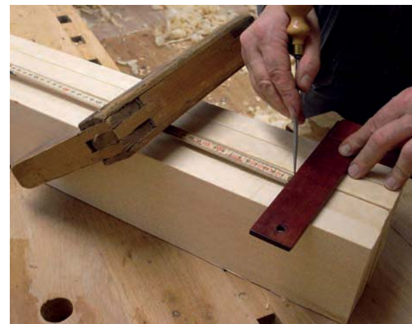
Bild 140. Ritsning av innermått och profilbredd.
