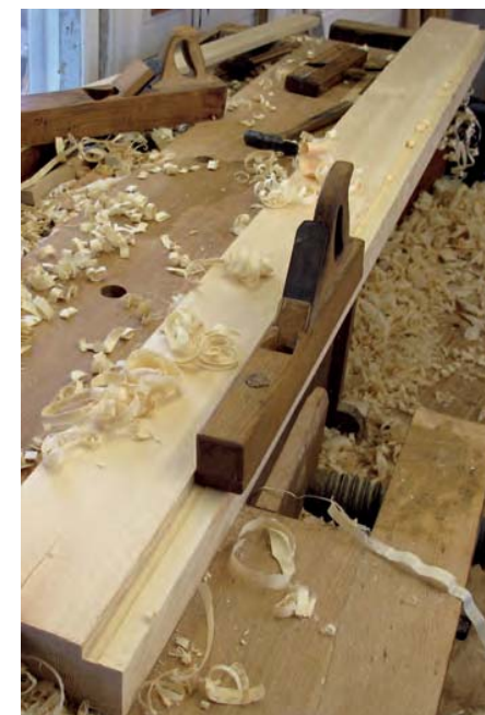
Bild 218. Det material som återstår efter simshyvlingen avverkas så nära ritsen som möjligt med en skrubbyvel.
