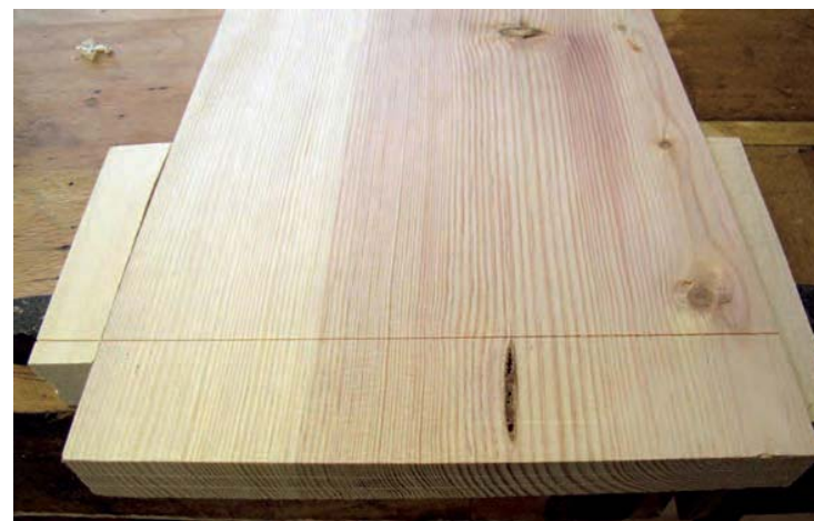
Bild 194. Rits som gjorts med frishyvelns förskär genom att dra den bakåt över stycket.
