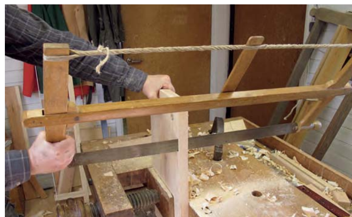
Bild 192. Fogen kantas med yxa eller såg innan bredmättet hyvlas.
