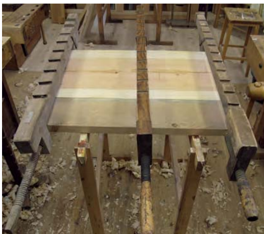
Bild 123. Limfogen ihopspänd med "knektar" av trä.
