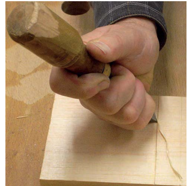
Bild 149. Ritsarna förstärks med stämjärnet med slipfasen vänd in mot stycket A och sedan skärs ett spår upp mot den förstärkta ritsen med fasen vänd ut mot styckets ände B .
