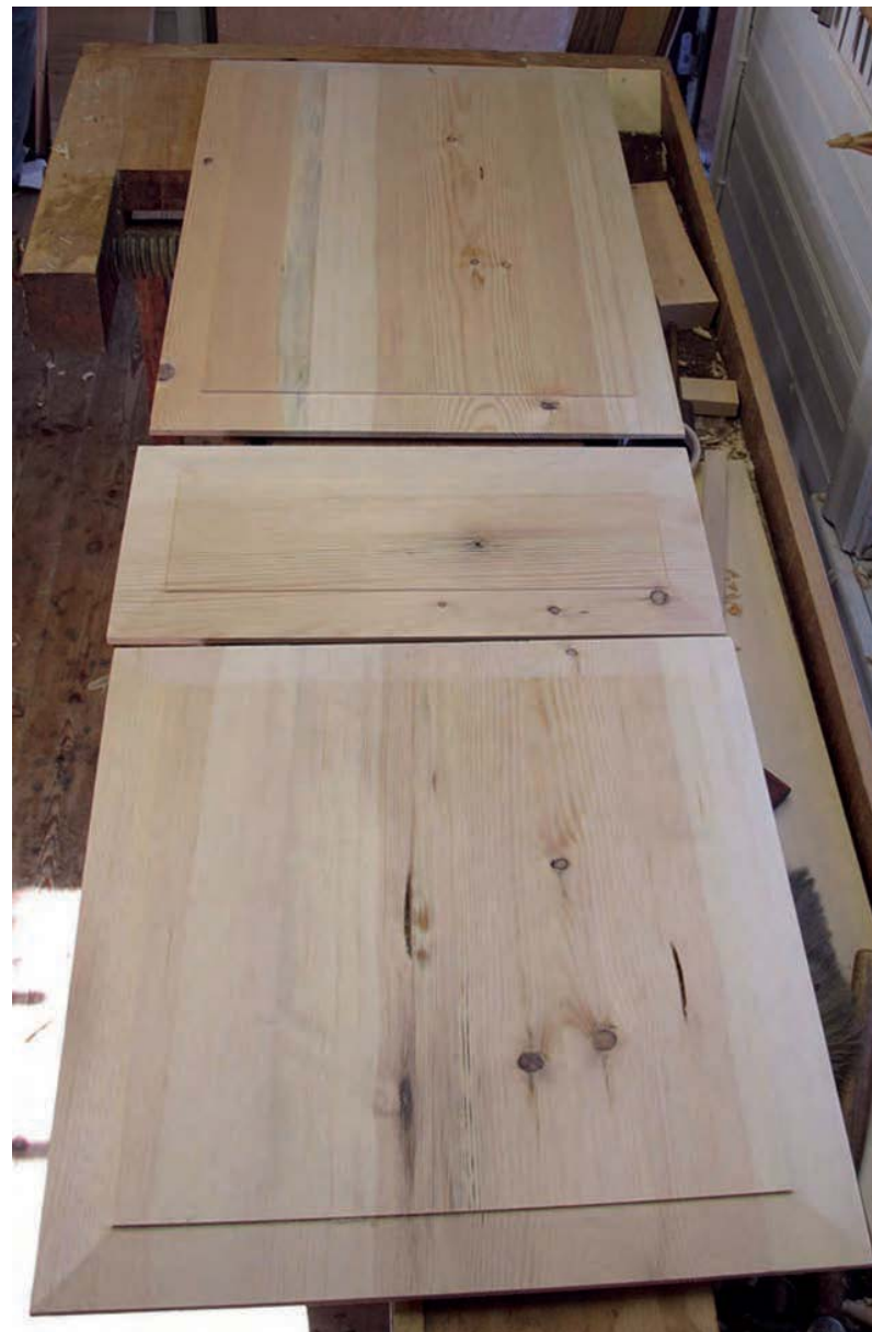
Bild 199. Fyllningar färdiga att montera i ramverket.
