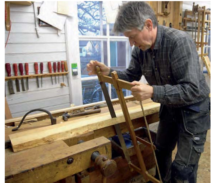
Figur 127. Kantning av ämne till sidstycke spänt mellan bänkhakarna. Klyvsåg, bladlängd 75 cm och 6 tpi.
