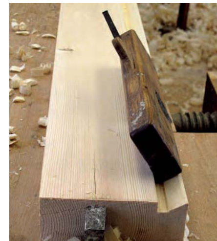
Bild 217. Med en simshyvel påbörjas avverkningen av det resterande efter nothyvlingen.
