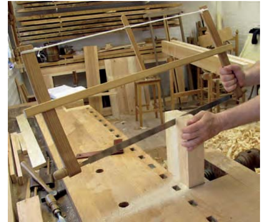
Bild 69. Tappstycket sågas "för fot" uppsatt i bänken .
