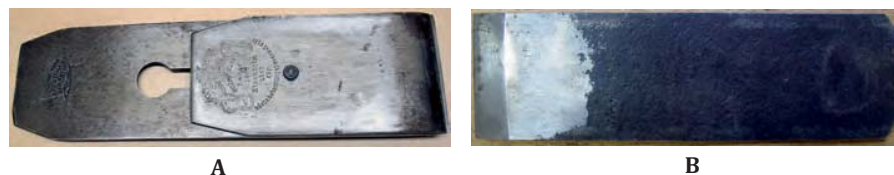
Bild 55. Ett dubbeljárn A är ett stål med klaff och enkeljárn B utan klaff.
