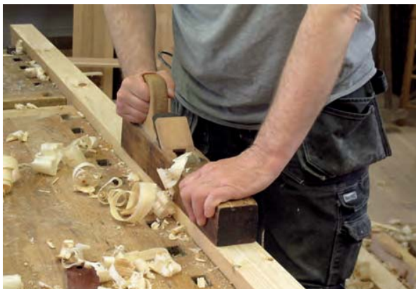
Bild 212. Breddmättet hyvlas med grovsläthyvel och rubank.
