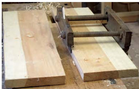
Bild 120. Stycket hyvlas först till hälftenfrån en sida A och vänds och hyvlas klart från andra sidan B.
