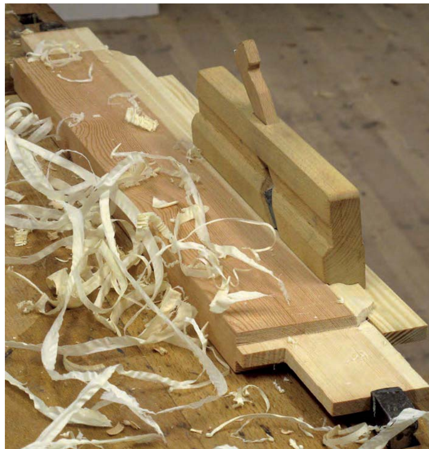
Bild 185. Profilhyvling med en isatt list som djupstopp för hyveln.
