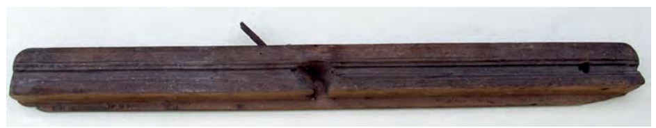
Bild 16. A Falshyvel med ställbart anhåll och djupstopp. Hyveln är försedd med förskår som underlättar hyvling tvärs över fiberriktningen. B 60 cm lång falshyvel med fast anhåll, utan djupstopp. C 65 cm lång falshyvel med anhåll och djupstopp. Falsen hyvlas tills djupstoppet stannar mot ytan X.
