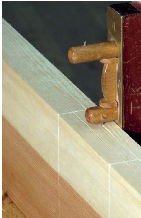
Bild 173. Tapphålén ritsas med strykmåttets anhåll mot den triangelmärkta sidan.
