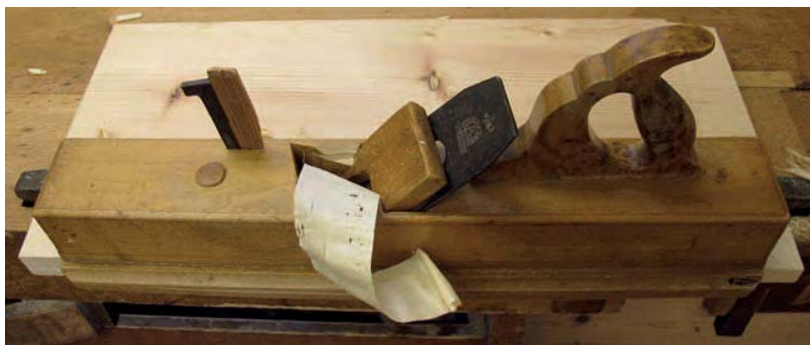
Bild 196. Frishyvlning längs med fiberriktningen med förskäret uppdraget.
