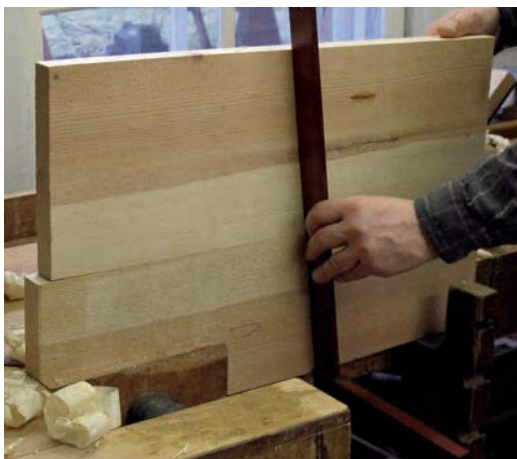
Bild 122. Kontroll av fogens planhet.
