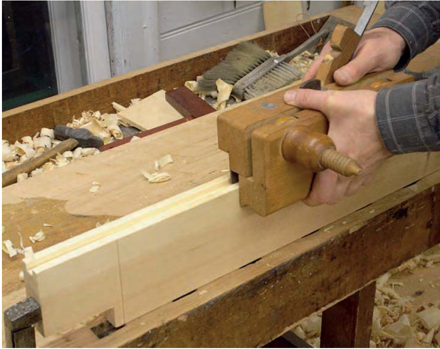
Bild 148. Tvärstyckena urnotas innan slitningarna sågas bort.
