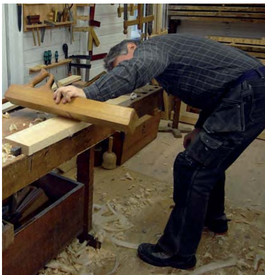
Bild 131. Styckets planhet kontrolleras med rubankens kant.
