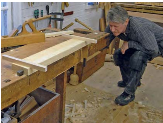
Bild 130. Styckets eventuella skevhet kontrolleras med riktribbor.
