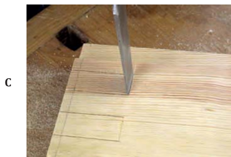
Bild 225. Först vändes stämjärnets fas från änden och lutats något så att en mindre del av eggen skär i ritsen A . Därefter vändes järnet med fasen åt motsvarande håll och ett spår skärs upp B där järnet placerades vid huggningen C . Detta motverkar att järnet trycks in i träet utanför ritsen, vilket skulle göra att huggningen inte följer ritsen. Det får till följd att sammansättningen blir otät.
