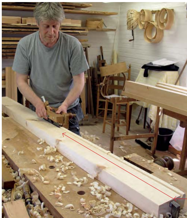
Bild 216. Notspåret hyvlas med start vid änden A för att sedan fortsättas bakåt i pilens riktning.
