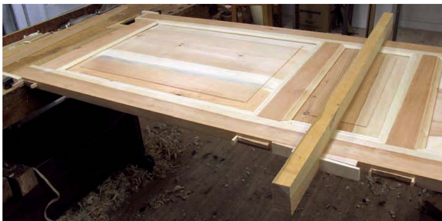
Bild 200. dörrbladet ihospänt mellan bänkhakar och med kiltving.
