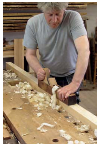
Bild 206. Riktning av första kanten med grovsläthyvel.
