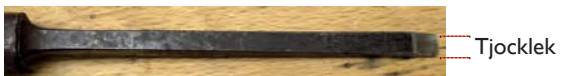
Bild 31. Lockbettel. Lockbetteln användes framförallt för att stämma djupa hål som tapphål. Järnets tjocklek bestämde hålets bredd. Det vanliga var att man valde tapphållets bredd till en tredjedel av styckets tjocklek. Nynäsdörren var 28 mm tjock och tappens 10 mm tjock.
