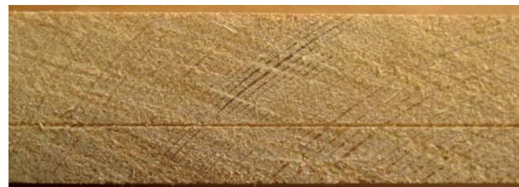
Bild 193. Ritsar för frisens hyvlingsdjup på fyllningens kant.
