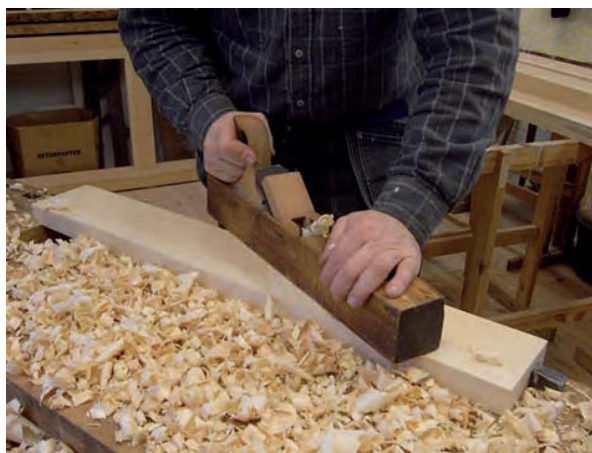
Bild 136. Diagonalhyvling med grovsläthyvel.
