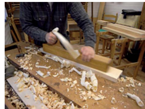
Bild 138. Avslutande tag ned till ritsen med rubank.
