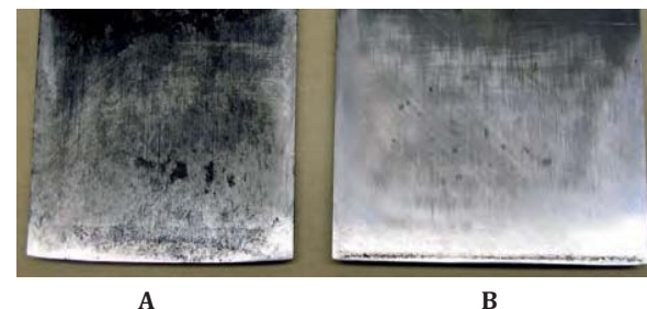
Bild 57. Stål till grovsläthyvel A och rubank B .
