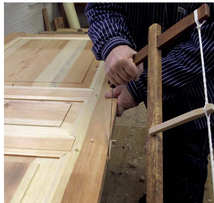
Bild 202. Tapparnas övermått kapas bort.
