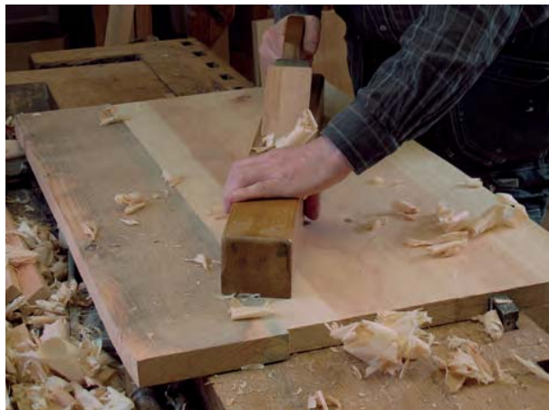
Bild 186. Hyvling med "dubbel-rubank" tvärs över stycket.
