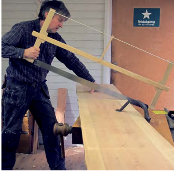
Bild 115. Plankorna sätts fast med en bänkhållare och kapas med en spännsåg. Bladlängd 60 cm och 6 tpi.
