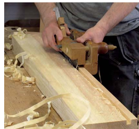
Bild 215. Med en nothyvel inställd på falsens bredd- och djupmått drogs ett notspår upp. Nothyveln var försedd med både ställbart djupstopp och anhåll.
