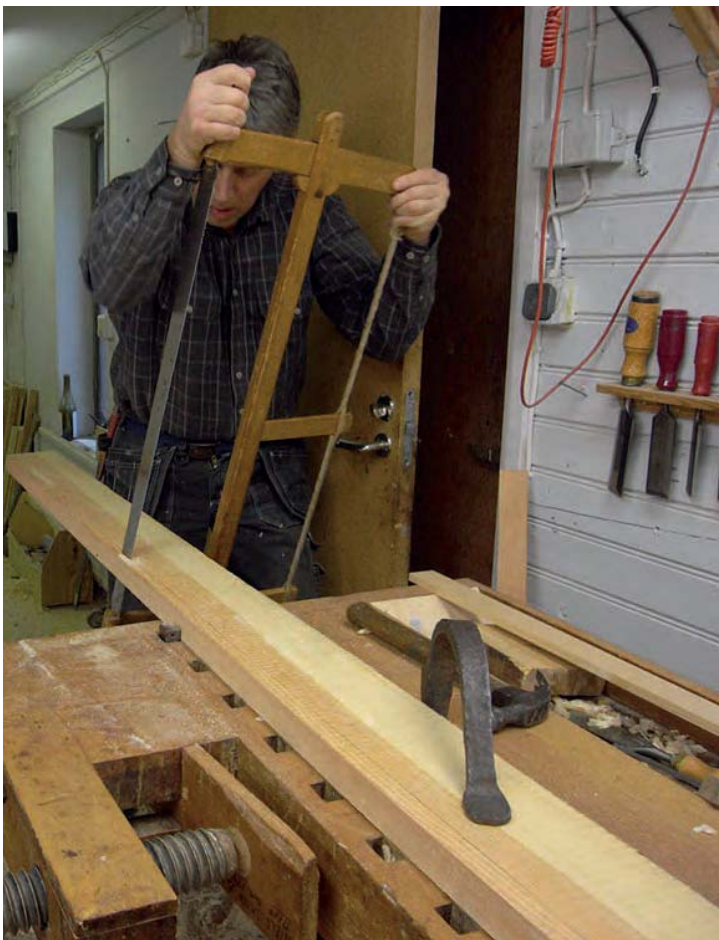
Bild 128. Klyvning med stycket fasthållet med bänkhållare och utskjutet vid bänkens ände.
