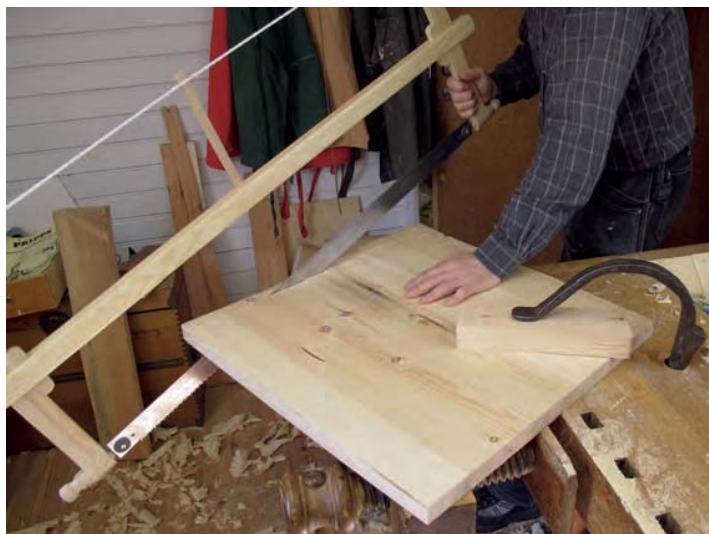
Bild 190. Första änden sågas i vinkel.
