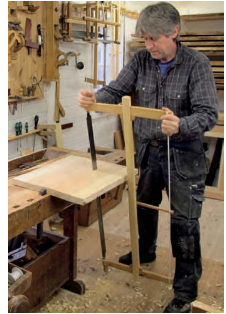
Bild 118. Ämnet klyvs i märgen. Bladlängd 96 cm och 5 tpi.
