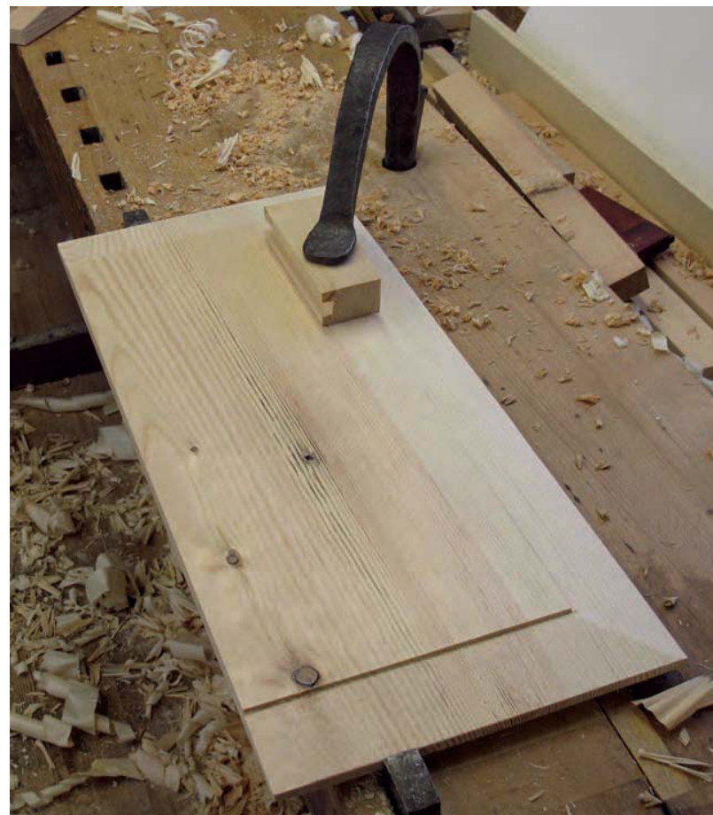
Bild 197. Fyllningen nedspänd med bänkhållaren när frisen hyvlas på sida två för att undvika att den tippas vid hyvlingen.
