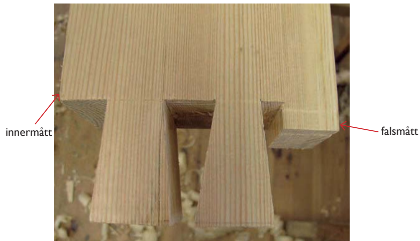
Bild 230. Sidstycket kapas vid falsmåttet och vid innermåttet på andra kanten
