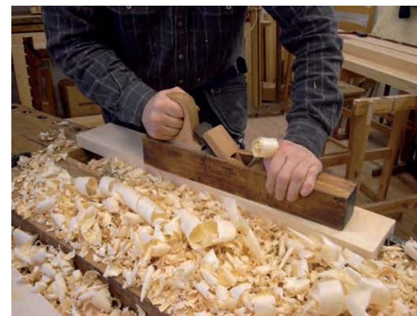
Bild 137. Grovsläthyvling längs med fibrerna.
