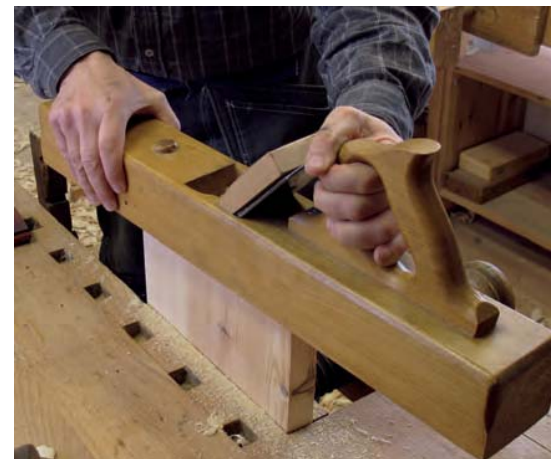
Bild 191. Stöthyvling av ändträt på kortsidorna från kanterna in mot mitten.
