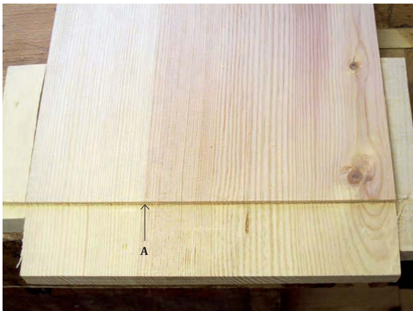
Bild 195. Fris hyvlad tvärs fiberriktningen. Frisens innerkant A.
