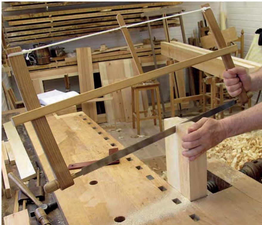
Bild 223. Tappstycke uppsatt i hyvelbänkens framtång för sågning av tappsinkorna.
