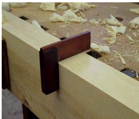
Bild 208. Kontroll av vinkel mitt på stycket mot den ohyvlade sidan.
