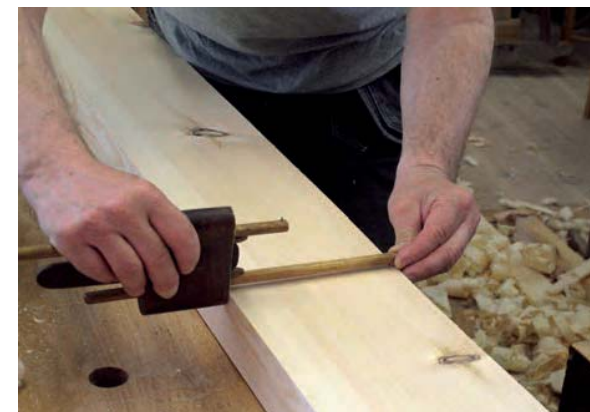
Bild 211. Ritsning av bredmättet 150 mm.
