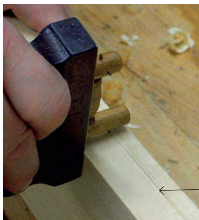
Bild 142. Strykrätmåttet ställs in efter markeringen från nothyveln.
