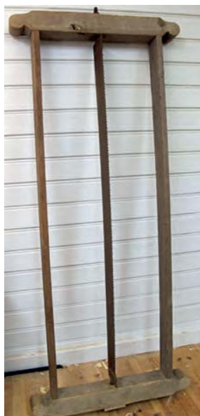
Bild 119. Klosåg. Bladlängd 120 cm och 3,5 tpi.
