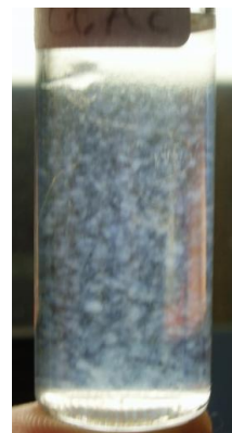
Figur 13 Exempel på lösligheten hos Plextol D 360 med lösningsmedlen etanol/Aceton, Etylacetat eller aceton.
