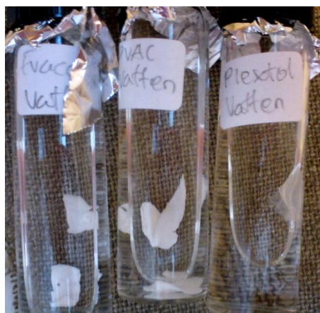
Figur 11: Test av löslighet i vatten. Efter 1h har Evacon-R t.v. och Bind-flex 1161 mitten blivit vita och opaka. Plextol t.h. opåverkad
