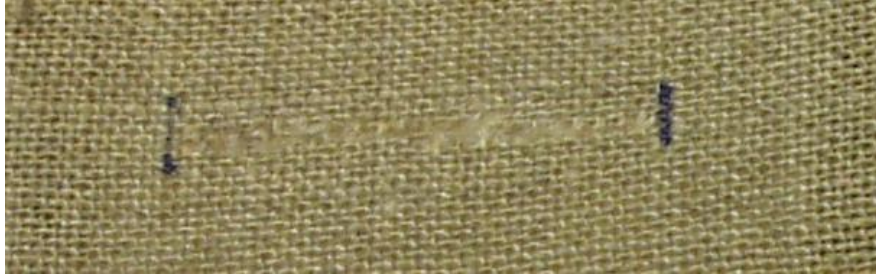
Figur 7. Prov med lagning av reva med trådflättningsmetoden.
