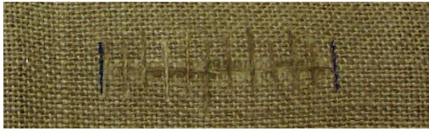
Figur 8. Prov med lagning av reva med trådbryggor
