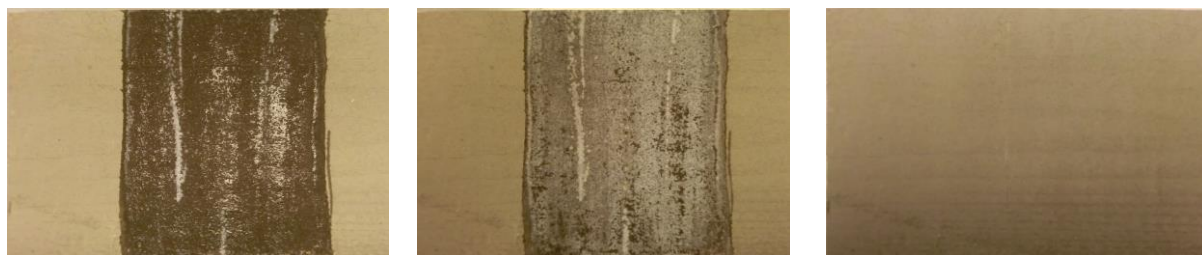
Figur 7: Provyta 6D(a). Från vänster; behandlad med mättad mentollösning 4:5, därefter konsoliderad med gelatinlösning varpå en vit hinna bildas. Bilden t.h. är tagen 19h efter applicering.
