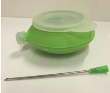
Figur 2: "Decopen" (denna rymmer 90 ml, finns även för 350 ml) av fabrikat Lékué, här med en injektionsnål med diametern, 2 mm, en storlek som används i samband med konservering av muralmåleri och injicering av bruk.
