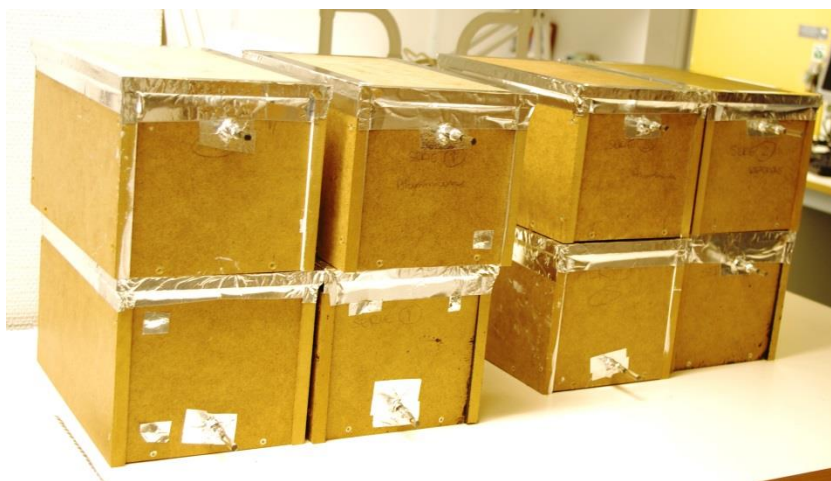
Figur 2: Färdigbyggda lådor, serie ett och serie två, förseglade för avgasning under sju dagar.
