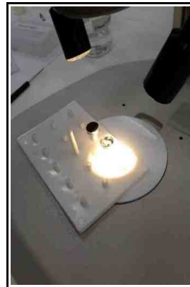
Fig. 30. Först rivs pigmentet på glas. Fig. 31. Därefter placeras preparatet på den så kallade "stubben". Nu är allt klart för analys.
