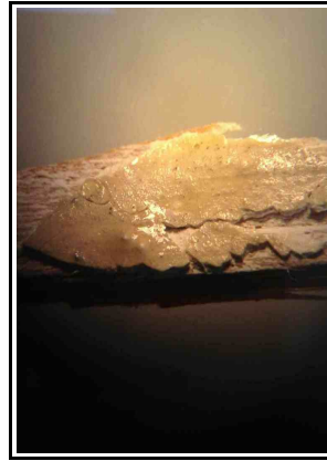
Fig. 26 och 27. Arbetsmikroskopet på bild 26 gav en förstoring av preparatet med 50 ggr. På bild 27 syns den gulnade fernissan, hur den spruckit och separerar från färgskiktet.
