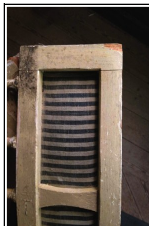
Fig. 24 och 25. Stolens sittdel bild 24 och dess rygg bild 25. Färgen är ursprunglig men har dålig vidhäftning. Färgen är också missfärgad, fennissan har "gulnat".
