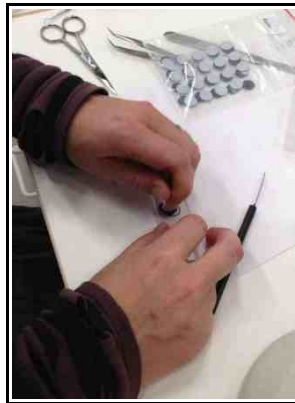
Fig. 30. Först rivs pigmentet på glas. Fig. 31. Därefter placeras preparatet på den så kallade "stubben". Nu är allt klart för analys.
