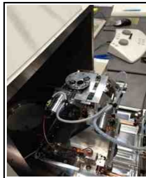
Fig. 32. "Stubben" är placerad i mikroskopet. Fig. 33. Mikroskåpet är klart för analys av preparatet.
