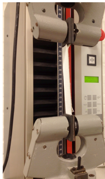
Figur 12. Skjuvtest av lamineringsprov med Zwick 4031
