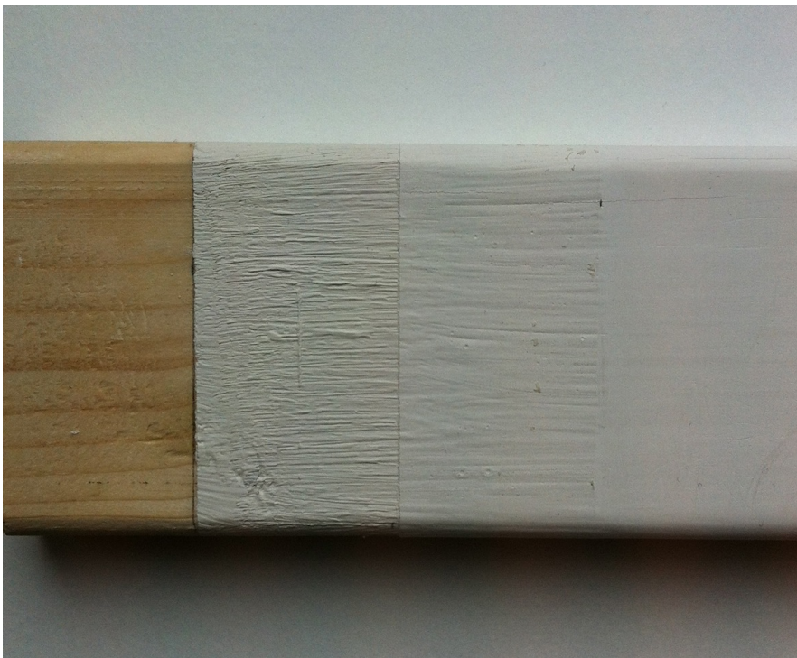
Referensplatta. Notera den slipade ytan till höger i bild. Foto: Billy Höök
