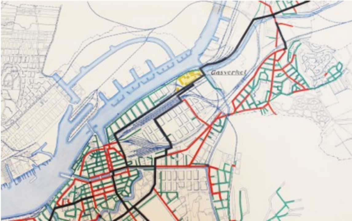
Bild 6: Gullbergskaj med omnejd: Gasverkets huvdurörnät 1922. Linjernas färger anger gasledningarnas tjocklek. Svart = 600-300 mm.dm, Röd = 250-150 mm. dm, Grön = 125-75 mm.dm. Min gissning är att dessa representerar högtrycks respektive lågtrycksledningar.
