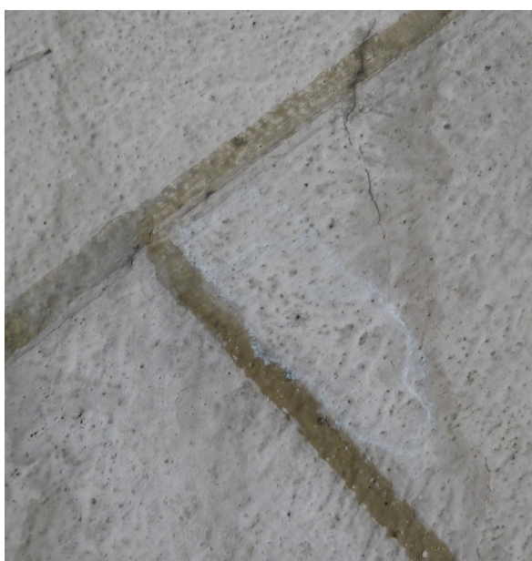
Figur 28. CaOH/1-propanol med inpackning av BaOH/1-propanol. Får en vit fällning i kanterna, möjligen bariumkarbonat.
