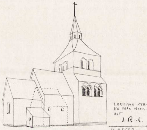
Fig. 3. Lokrume kyrka från nordost, med rekonstruktion i prickade linjer af det äldsta långhuset. Teckning af förf.
